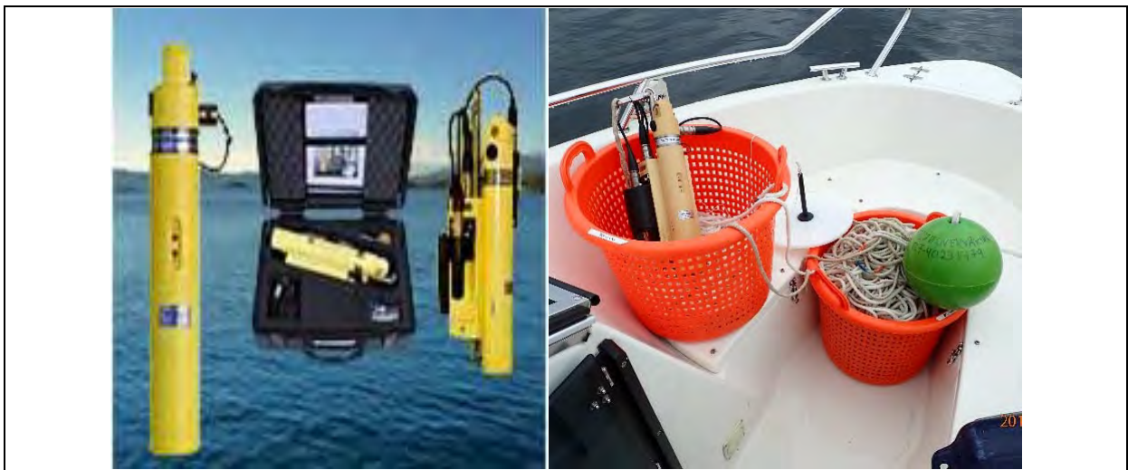
Figur 3.4 SD204 CTD-måler med klorofyll-sensor og ny optisk oksygen-sensor.
