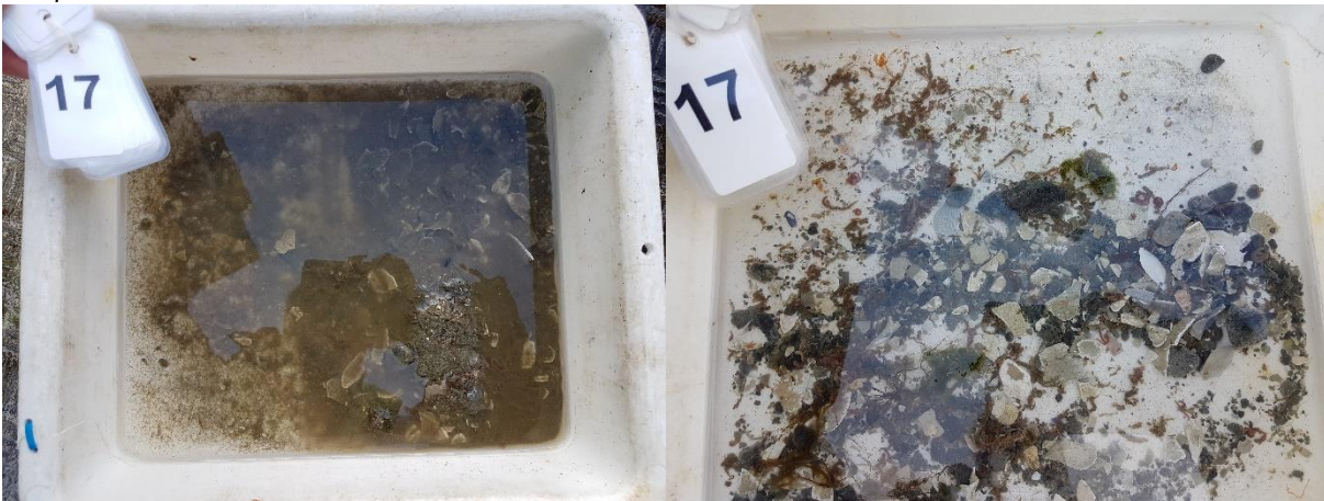
Figur 22: Bilder som viser sedimentet fra stasjon 17 før og etter siling. Sedimentet besto av sand, silt og grus på steinbunn. Foto: Aqua Kompetanse AS.
