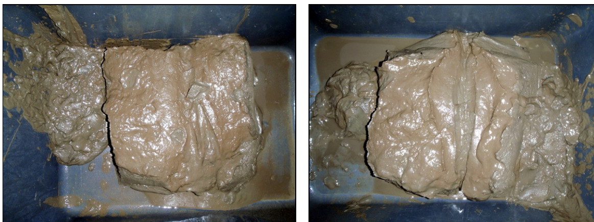
Figur 6. Bilder av sediment fra de to parallelle prøvene fra stasjon S16 i dypålen til Ålfjordbotn utenfor Fjonavika 23. november 2011. Prøvene bestod av luktfritt, mykt og grått finsediment.
