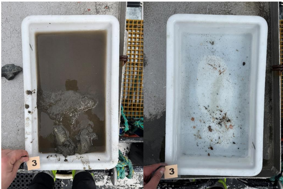
Figur 3: Bilder som viser substratet fra stasjon 3 før og etter siling. Foto: Aqua Kompetanse AS.
