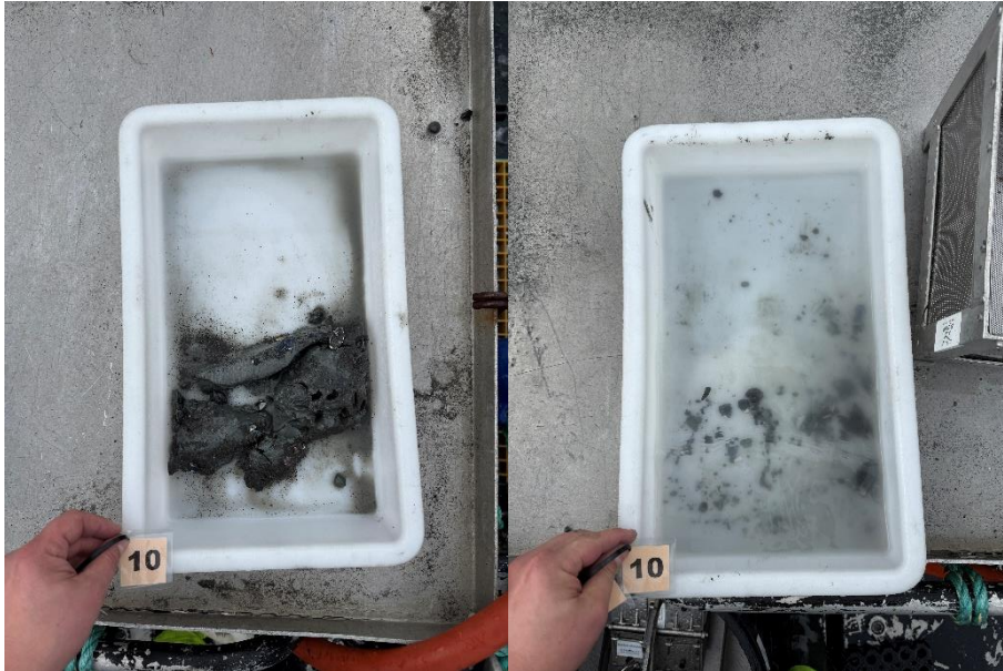
Figur 10: Bilder som viser substratet fra stasjon 10 før og etter siling. Foto: Aqua Kompetanse AS.
