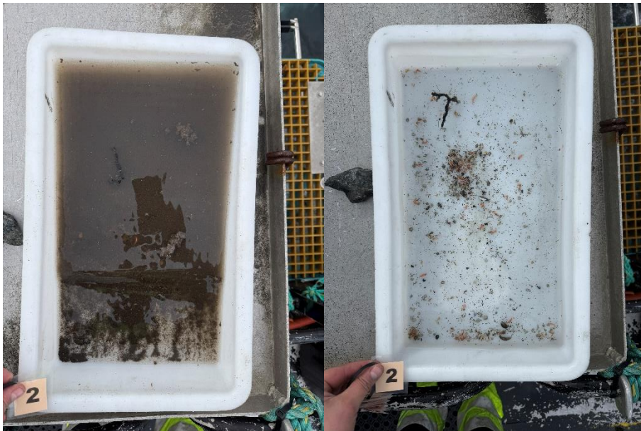
Figur 2: Bilder som viser substratet fra stasjon 2 før og etter siling. Foto: Aqua Kompetanse AS.
