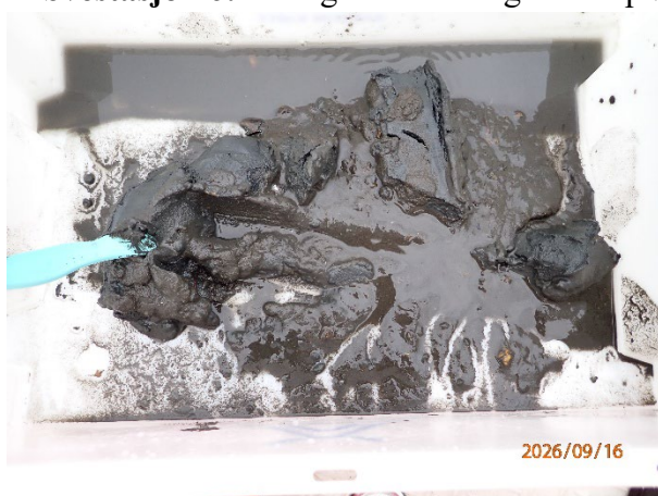
Prøvestasjon 6: Silt og leire. Grå og luktfri prøve med mjuk konsistens.
