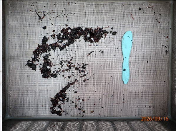
Prøvestasjon 4: Silt og leire. Grå og luktfri prøve med mjuk konsistens.
