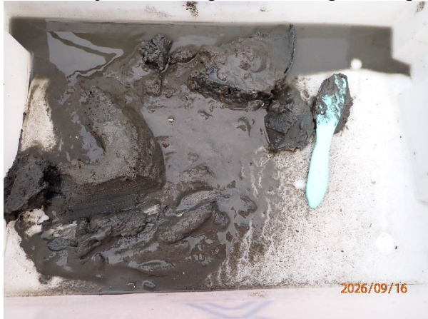
Prøvestasjon 4: Silt og leire. Grå og luktfri prøve med mjuk konsistens.
