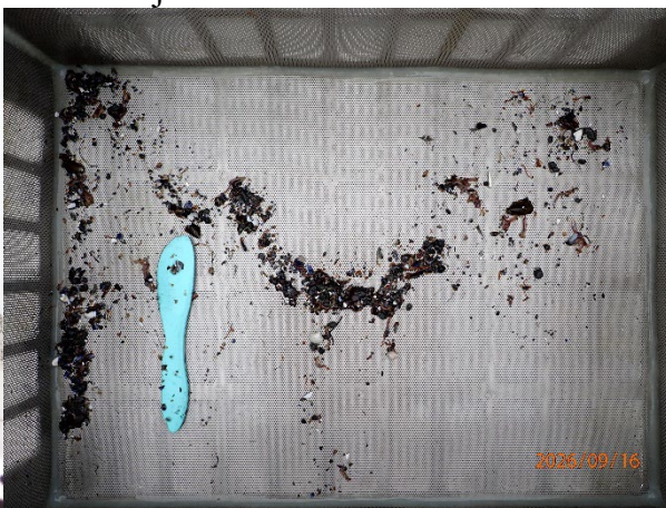
Prøvestasjon 6: Silt og leire. Grå og luktfri prøve med mjuk konsistens.
