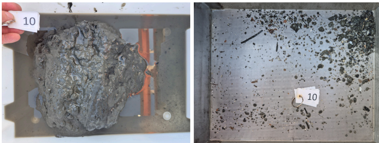
Figur 16. Bilder av sedimentet hentet opp fra prøvepunkt 10. Uvasket prøve til venstre og vasket/silt prøve til høyre.
