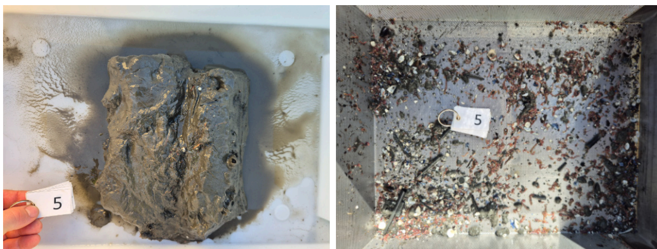
Figur 11. Bilder av sedimentet hentet opp fra prøvepunkt 5. Uvasket prøve til venstre og vasket/silt prøve til høyre.
