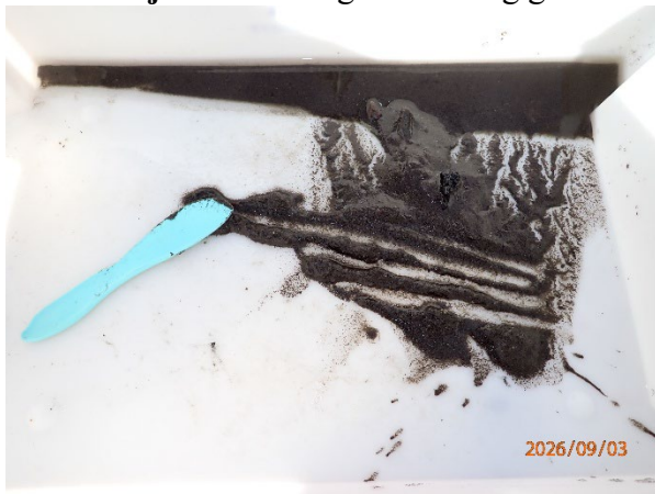
Prøvestasjon 12: Silt og litt sand og grus. Grå og luktfri prøve med mjuk konsistens.
