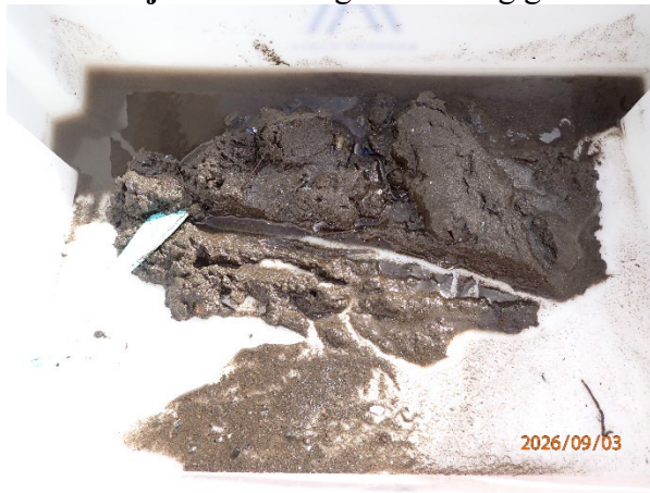
Prøvestasjon 11: Silt og litt sand og grus. Grå og luktfri prøve med mjuk konsistens.
