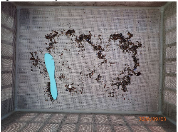
Prøvestasjon 8: Silt. Mørk farge og noko lukt i prøve med mjuk konsistens.
