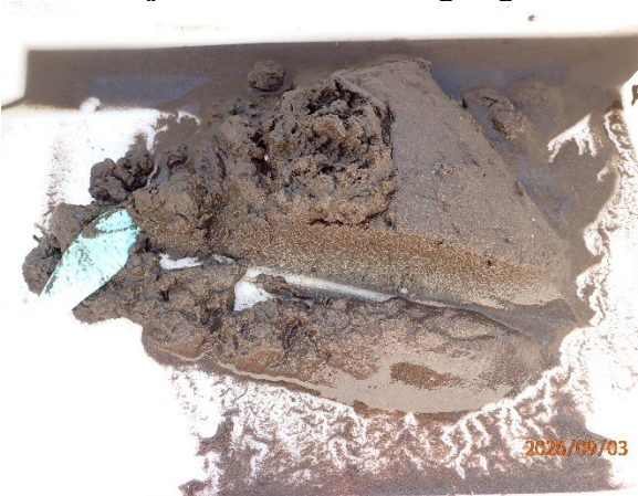
Prøvestasjon 8: Silt. Mørk farge og noko lukt i prøve med mjuk konsistens.
