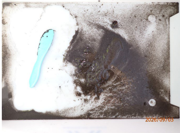
Prøvestasjon 10: Silt og litt sand og grus. Grå og luktfri prøve med mjuk konsistens.
