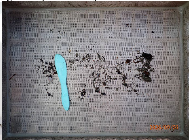
Prøvestasjon 12: Silt og litt sand og grus. Grå og luktfri prøve med mjuk konsistens.
