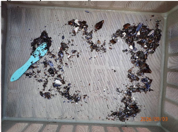
Prøvestasjon 11: Silt og litt sand og grus. Grå og luktfri prøve med mjuk konsistens.
