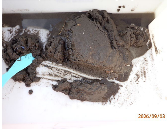
Prøvestasjon 7: Silt. Mørk farge og noko lukt i prøve med mjuk konsistens.
