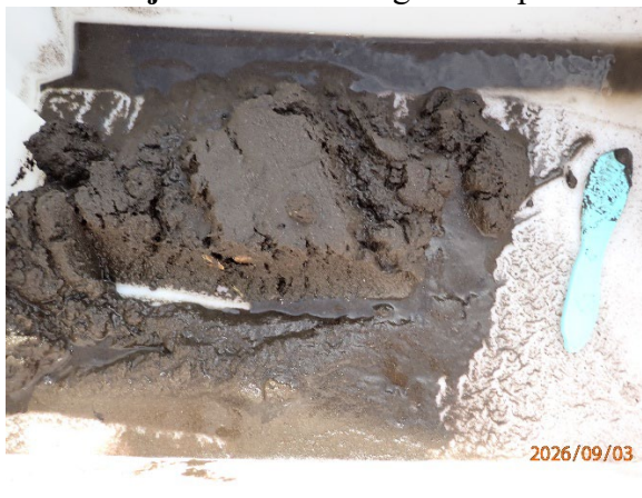
Prøvestasjon 9: Silt. Grå og luktfri prøve med mjuk konsistens.
