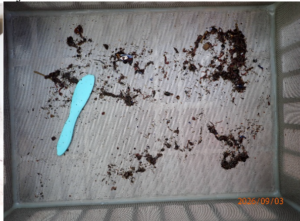
Prøvestasjon 9: Silt. Grå og luktfri prøve med mjuk konsistens.
