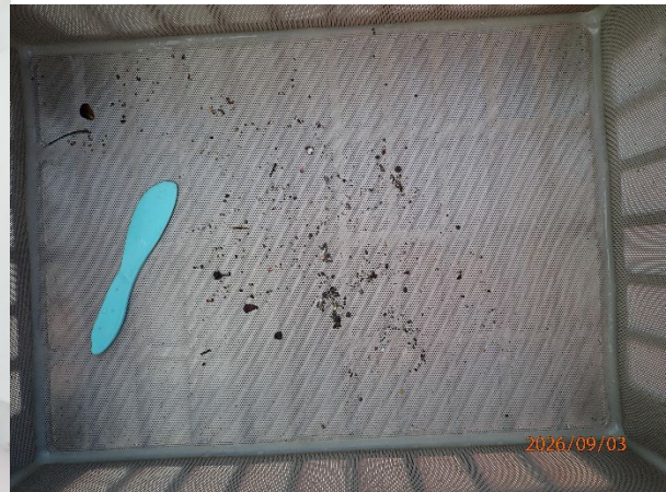
Prøvestasjon 10: Silt og litt sand og grus. Grå og luktfri prøve med mjuk konsistens.
