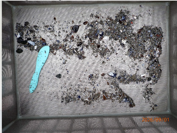
Prøvestasjon 10: Silt, sand, grus og skjelsand. Grå og luktfri prøve med fast konsistens.
