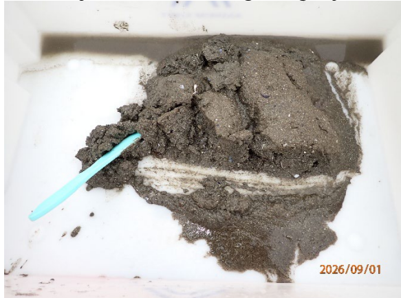
Prøvestasjon 10: Silt, sand, grus og skjelsand. Grå og luktfri prøve med fast konsistens.
