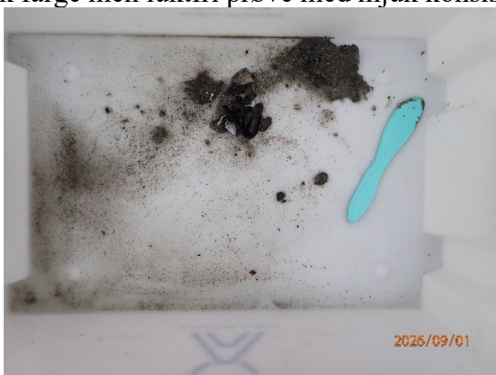
Prøvestasjon 11: Litt leire, silt, sand, grus og skjelsand. Mørk farge men luktfri prøve med mjuk konsistens.
