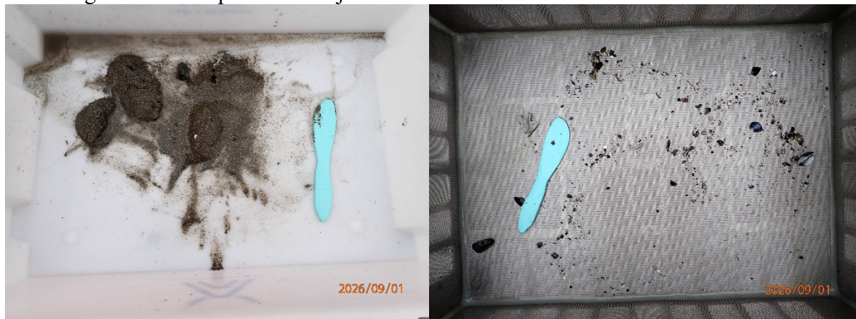
Prøvestasjon 9: Silt og litt sand, grus og skjelsand. Mørk farge men luktfri prøve med mjuk konsistens.
