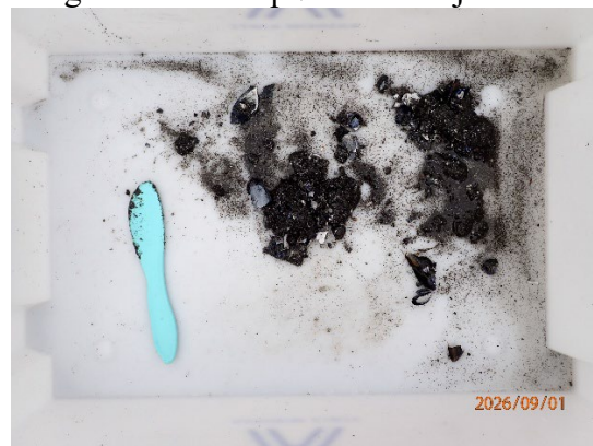
Prøvestasjon 12: Silt og litt sand, grus og skjelsand. Mørk farge men luktfri prøve med mjuk konsistens.
