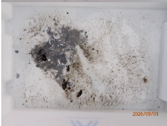
Prøvestasjon 12: Silt og litt sand, grus og skjelsand. Mørk farge men luktfri prøve med mjuk konsistens.
