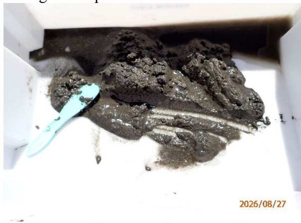
Prøvestasjon 14: Silt og sand, og litt grus og skjelsand. Grå og luktfri prøve med fast konsistens.
