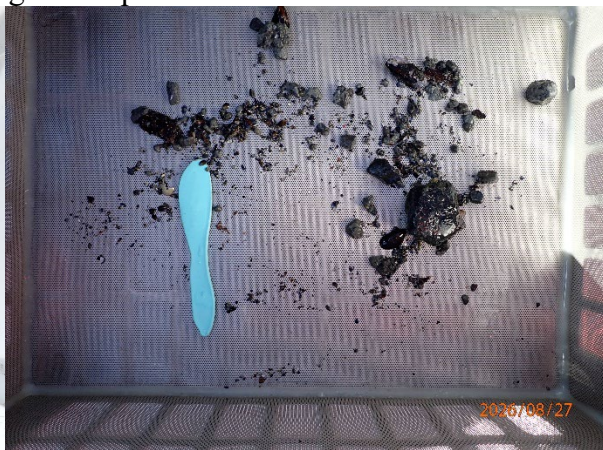
Prøvestasjon 6: Leire, silt, sand og grus. Grå og luktfri prøve med fast konsistens.
