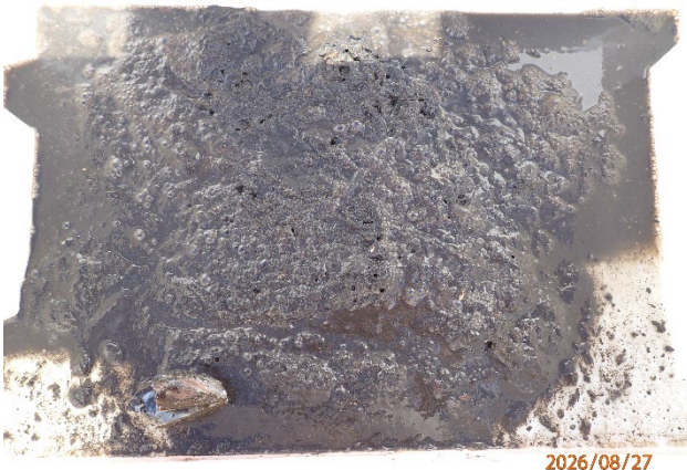
Prøvestasjon 8: Silt med fiskeskit. Mørk farge, gass og sterk lukt i prøve med laus konsistens.
