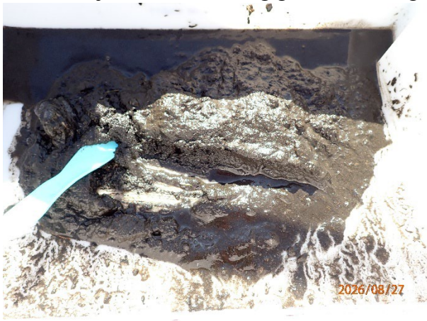
Prøvestasjon 4: Silt, sand og grus. Mørk farge og noko lukt i prøve med mjuk konsistens.
