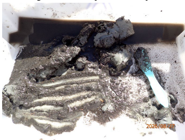
Prøvestasjon 5: Leire og litt silt, sand og grus. Mørk farge men luktfri prøve med mjuk konsistens.
