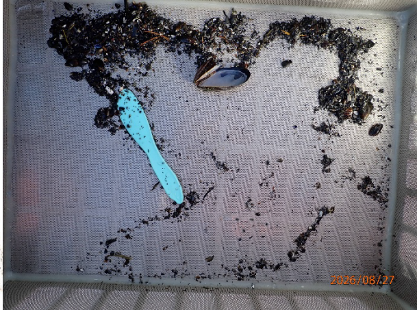
Prøvestasjon 4: Silt, sand og grus. Mørk farge og noko lukt i prøve med mjuk konsistens.
