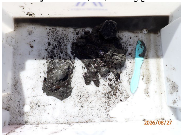
Prøvestasjon 6: Leire, silt, sand og grus. Grå og luktfri prøve med fast konsistens.
