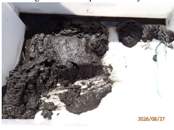
Prøvestasjon 13: Silt, og litt sand og grus. Mørk farge men luktfri prøve med mjuk konsistens.
