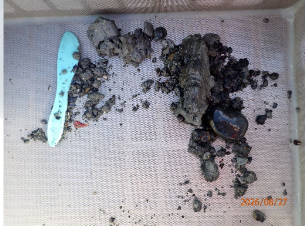
Prøvestasjon 3: Leire og litt silt, sand og grus. Grå og luktfri prøve med fast konsistens.
