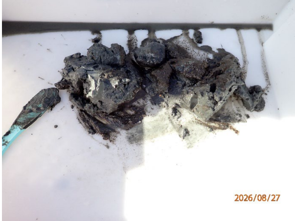
Prøvestasjon 3: Leire og litt silt, sand og grus. Grå og luktfri prøve med fast konsistens.
