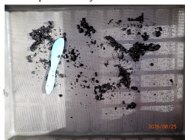
Prøvestasjon 8: Silt og leire. Mørk farge og noko lukt i prøve med mjuk konsistens.
