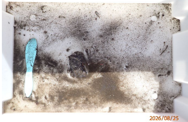
Prøvestasjon 12: Litt silt, sand og grus. Mørk men luktfri prøve med mjuk konsistens.
