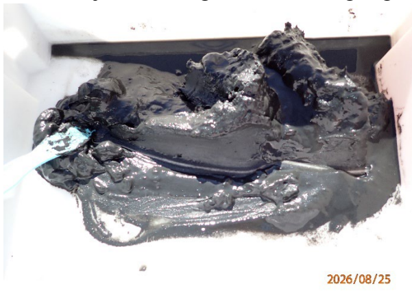
Prøvestasjon 6: Silt og leire. Mørk farge og noko lukt i prøve med mjuk konsistens.
