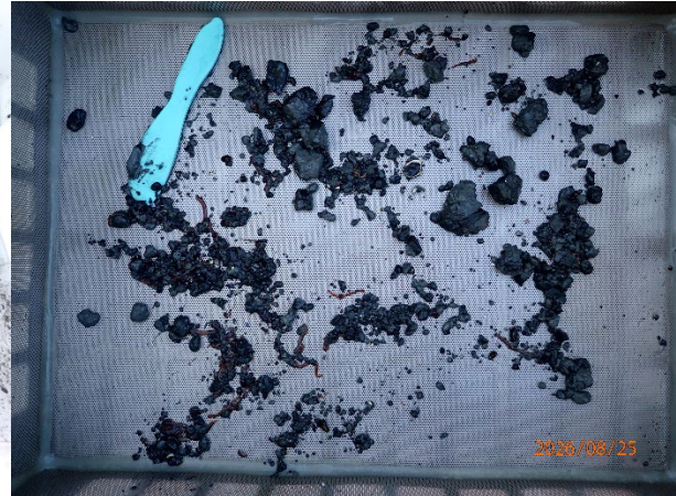
Prøvestasjon 6: Silt og leire. Mørk farge og noko lukt i prøve med mjuk konsistens.
