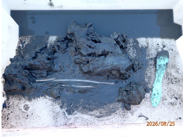
Prøvestasjon 5: Silt, leire, og litt sand og grus. Mørk farge men luktfri prøve med mjuk konsistens.
