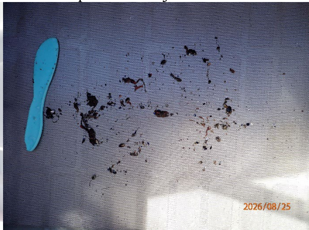
Prøvestasjon 12: Litt silt, sand og grus. Mørk men luktfri prøve med mjuk konsistens.
