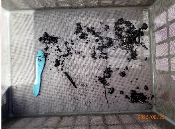
Prøvestasjon 6: Silt og leire. Mørk farge og noko lukt i prøve med mjuk konsistens.
