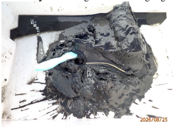
Prøvestasjon 8: Silt og leire. Mørk farge og noko lukt i prøve med mjuk konsistens.
