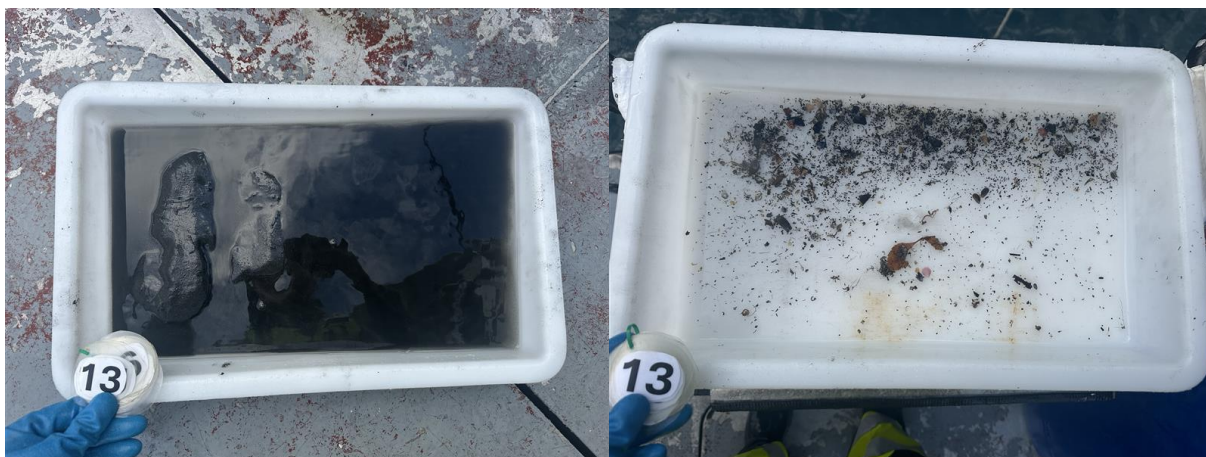
Figur 12: Bilder som viser substratet fra stasjon 13 før og etter siling. Foto: Aqua Kompetanse AS.
