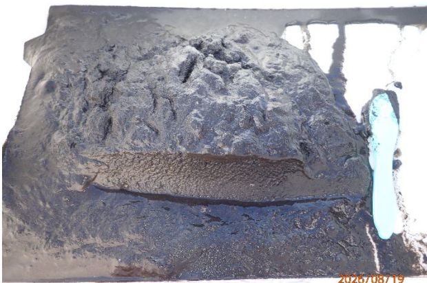
Prøvestasjon 6: Silt. Mørk farge og sterk lukt i prøve med mjuk konsistens.
