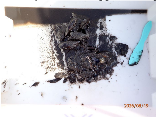
Prøvestasjon 11: Silt, sand og grus. Mørk farge men luktfri prøve med mjuk konsistens.
