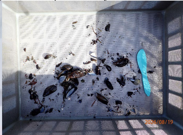
Prøvestasjon 11: Silt, sand og grus. Mørk farge men luktfri prøve med mjuk konsistens.
