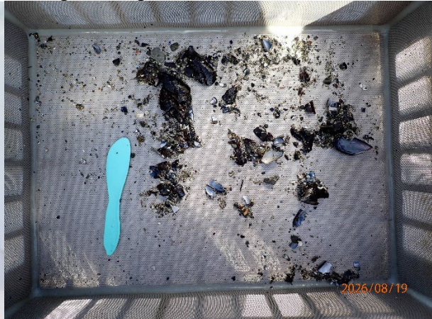
Prøvestasjon 12: Silt, sand, grus og skjelsand. Grå og luktfri prøve med fast konsistens.
