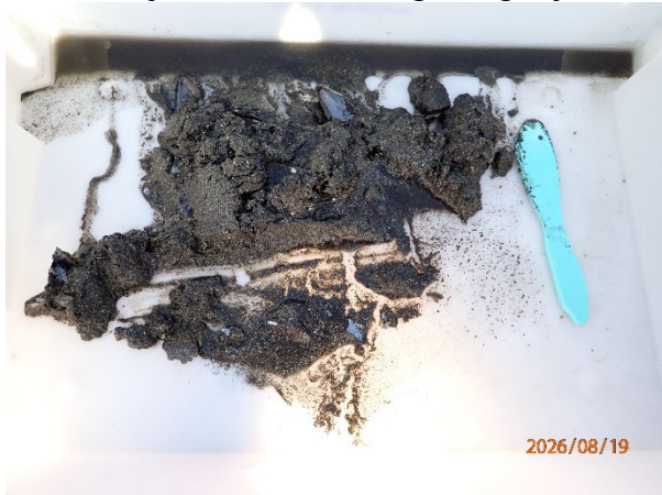
Prøvestasjon 12: Silt, sand, grus og skjelsand. Grå og luktfri prøve med fast konsistens.
