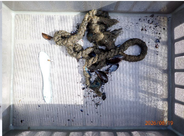
Prøvestasjon 11: Silt, sand og grus. Mørk farge men luktfri prøve med mjuk konsistens.
