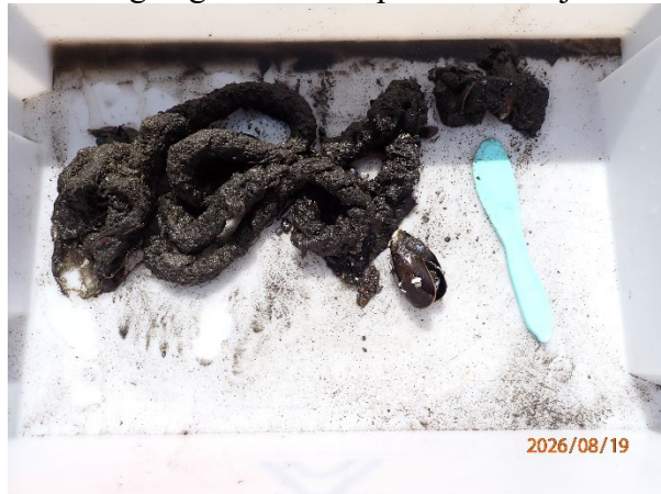
Prøvestasjon 10: Silt, sand og grus +ein tau rest. Mørk farge og noko lukt i prøve med mjuk konsistens.
