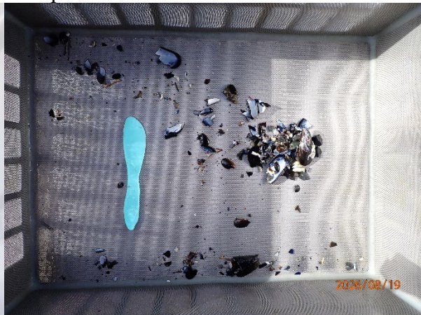
Prøvestasjon 4: Silt og sand og grus. Grå og luktfri prøve med fast konsistens.
