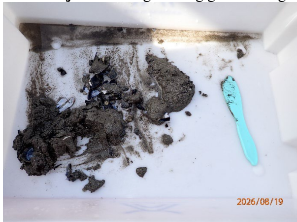
Prøvestasjon 4: Silt og sand og grus. Grå og luktfri prøve med fast konsistens.
