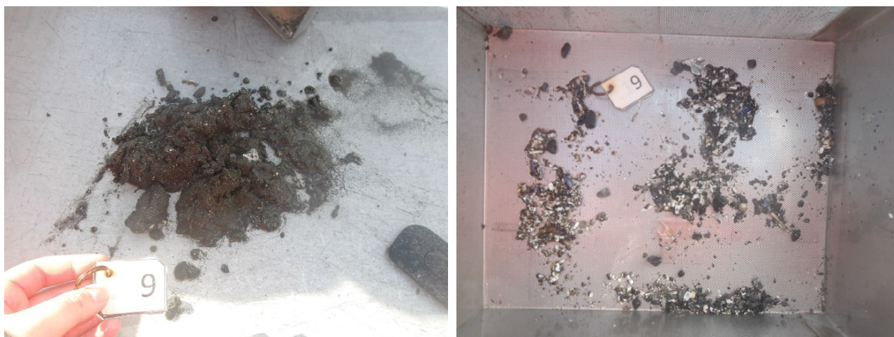
Figur 15. Bilder av sedimentet hentet opp fra prøvepunkt 9. Uvasket prøve til venstre og vasket/silt prøve til høyre.
