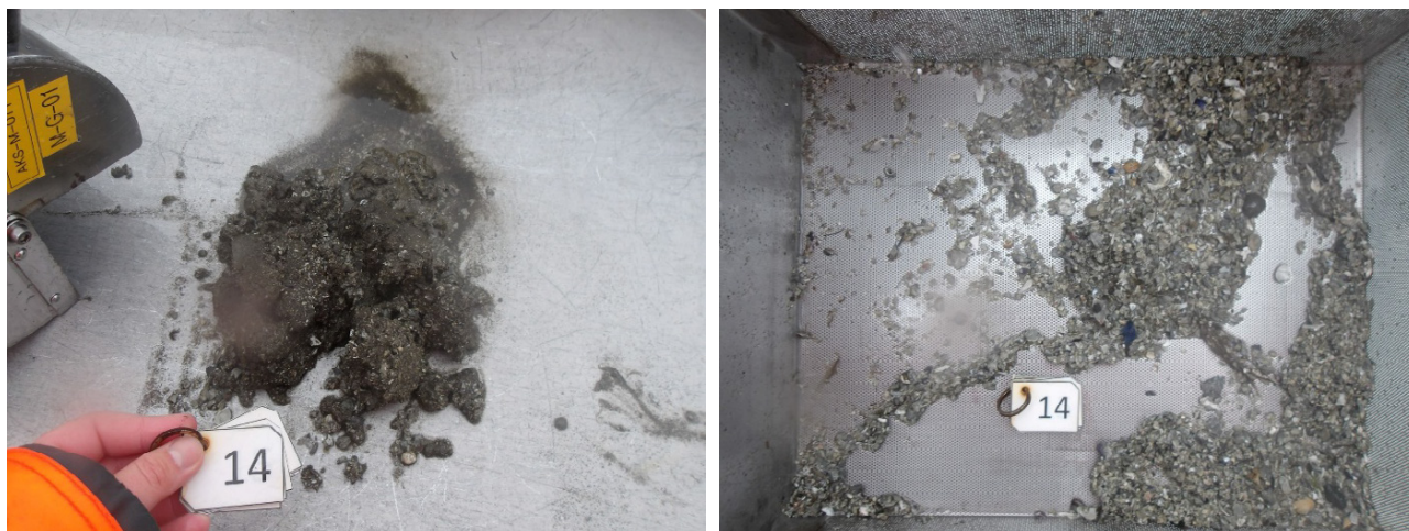
Figur 20. Bilder av sedimentet hentet opp fra prøvepunkt 14. Uvasket prøve til venstre og vasket/silt prøve til høyre.
