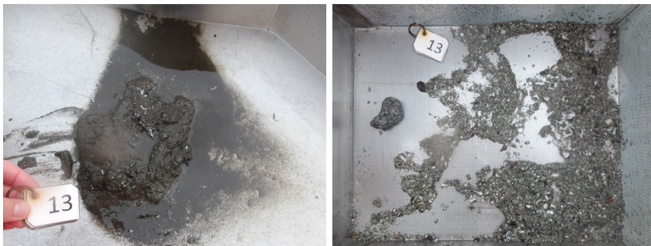
Figur 19. Bilder av sedimentet hentet opp fra prøvepunkt 13. Uvasket prøve til venstre og vasket/silt prøve til høyre.
