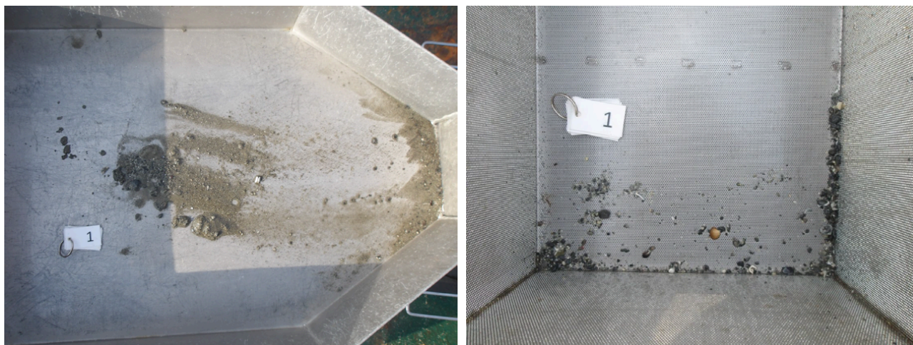
Figur 8. Bilder av sedimentet hentet opp fra prøvepunkt 1. Uvasket prøve til venstre og vasket/silt prøve til høyre.
