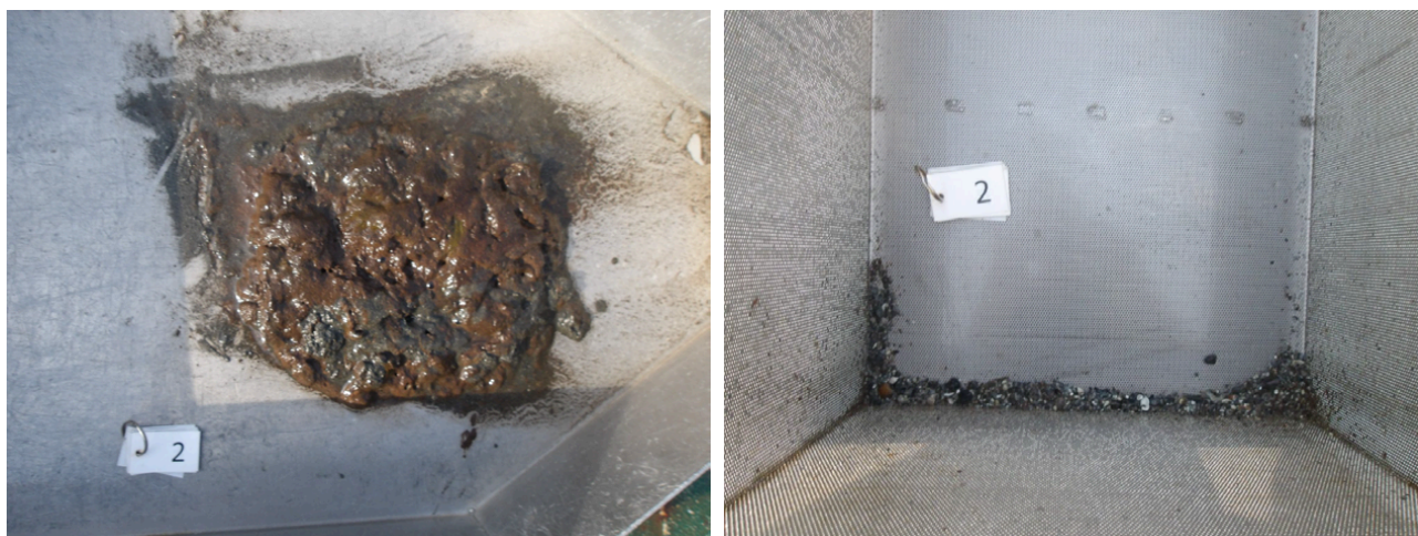
Figur 9. Bilder av sedimentet hentet opp fra prøvepunkt 2. Uvasket prøve til venstre og vasket/silt prøve til høyre.
