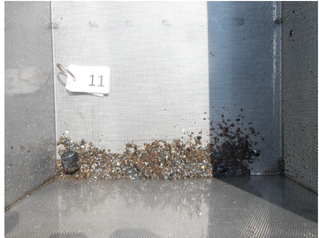
Figur 18. Bilder av sedimentet hentet opp fra prøvepunkt 11. Uvasket prøve til venstre og vasket/silt prøve til høyre.
