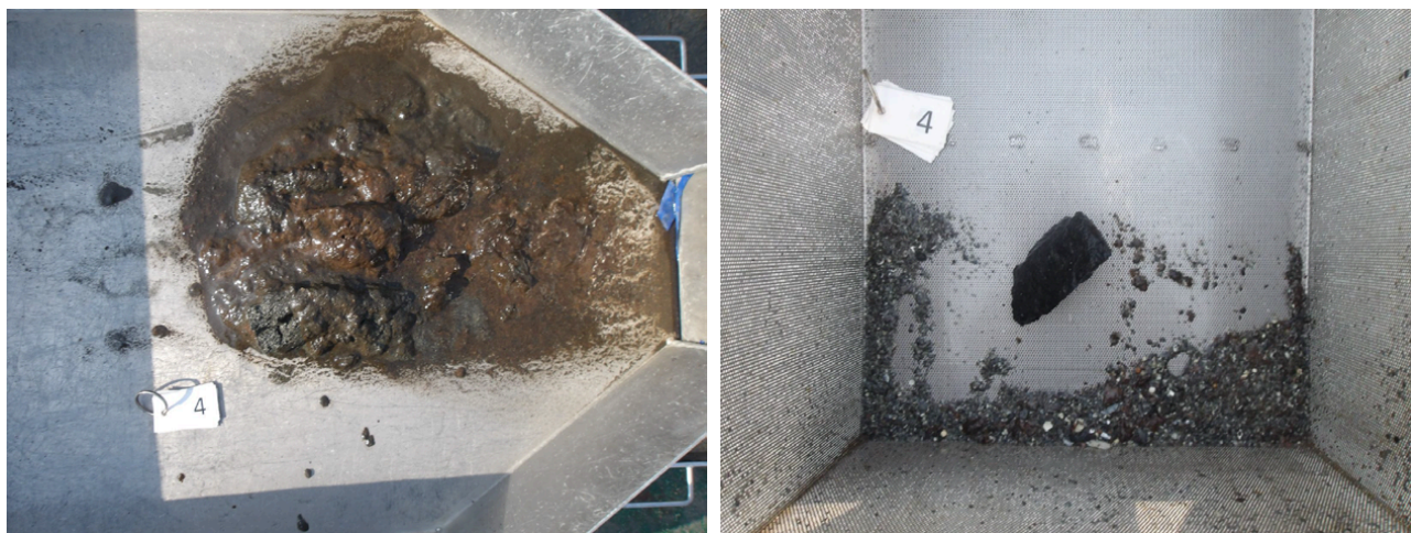
Figur 11. Bilder av sedimentet hentet opp fra prøvepunkt 4. Uvasket prøve til venstre og vasket/silt prøve til høyre.
