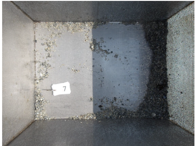
Figur 14. Bilder av sedimentet hentet opp fra prøvepunkt 7. Uvasket prøve til venstre og vasket/siltet prøve til høyre.
