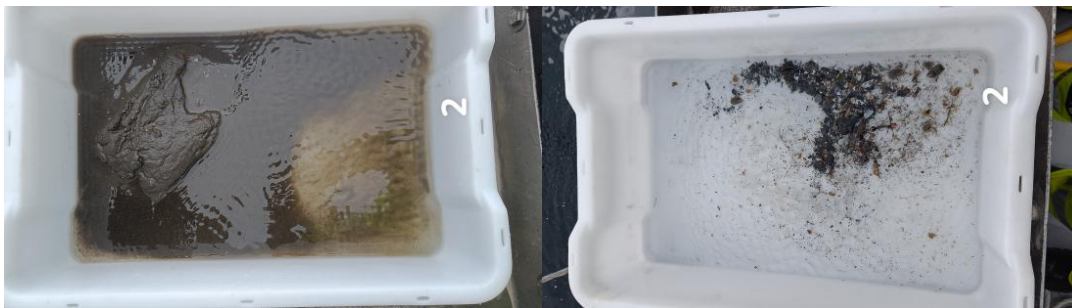
Figur B.2: Bilder før og etter siling ved stasjon 2. Sedimentet besto av silt, sand og grus.
