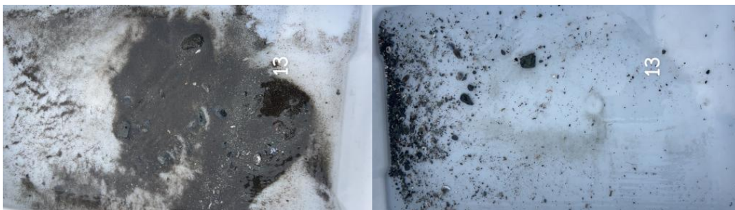
Figur B.13: Bilder før og etter siling ved stasjon 13. Sedimentet besto av sand og grus.
