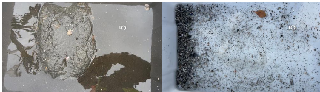
Figur B.5: Bilder før og etter siling ved stasjon 5. Sedimentet besto av silt og sand. Det ble registrert fôr og fekalier i denne prøven.
