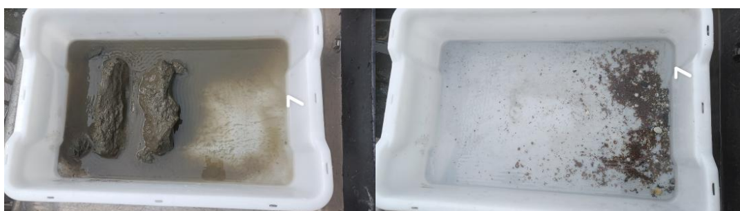
Figur B.7: Bilder før og etter siling ved stasjon 7. Sedimentet besto av silt og sand.
