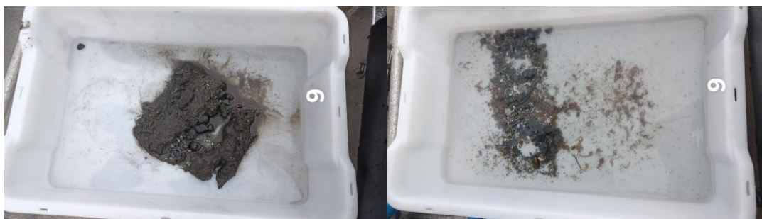
Figur B.9: Bilder før og etter siling ved stasjon 9. Sedimentet besto av silt og grus.
