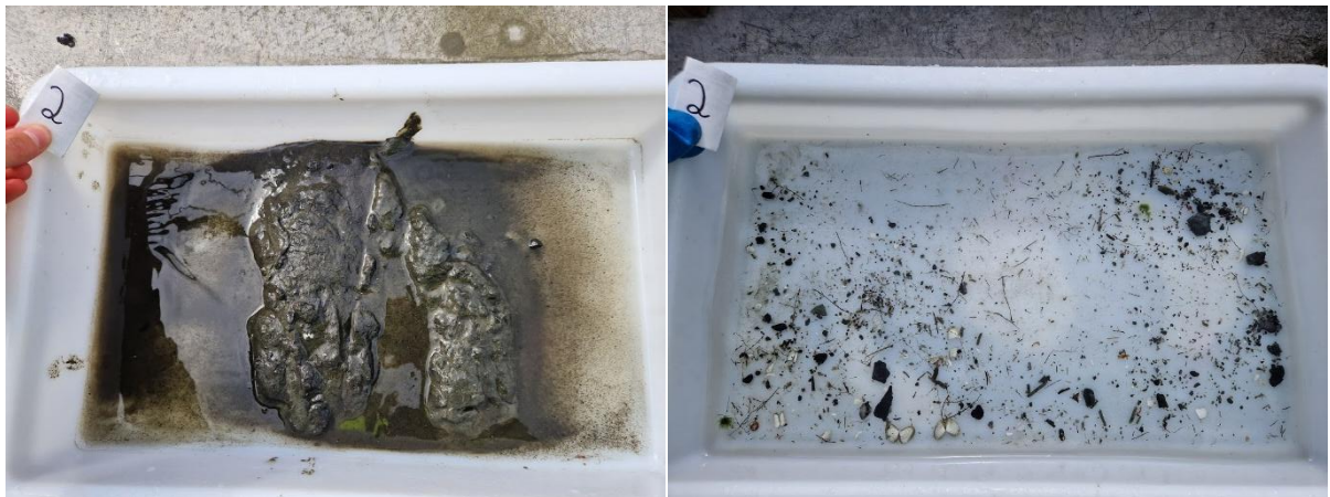
Figur 2: Bilder som viser substratet fra stasjon 2 før og etter siling. Foto: Aqua Kompetanse AS.
