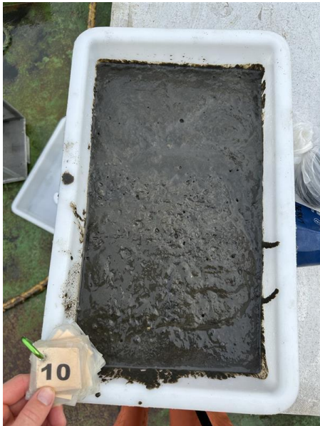
Figur 10: Bilder som viser substratet fra stasjon 10. Grabbinhold ble ikke silt grunnet H_2S -gass. Foto: Aqua Kompetanse AS.
