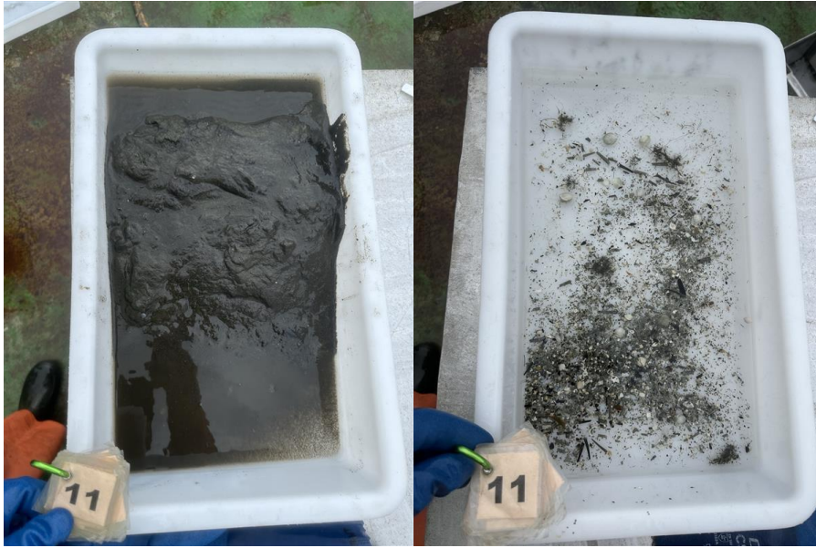
Figur 11: Bilder som viser substratet fra stasjon 11 før og etter siling. Foto: Aqua Kompetanse AS.
