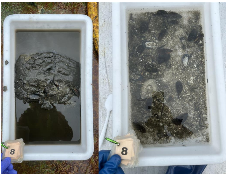
Figur 8: Bilder som viser substratet fra stasjon 8 før og etter siling. Foto: Aqua Kompetanse AS.
