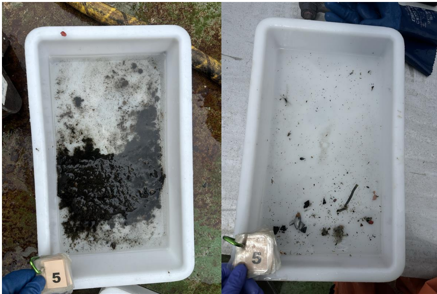
Figur 5: Bilder som viser substratet fra stasjon 5 før og etter siling. Foto: Aqua Kompetanse AS.
