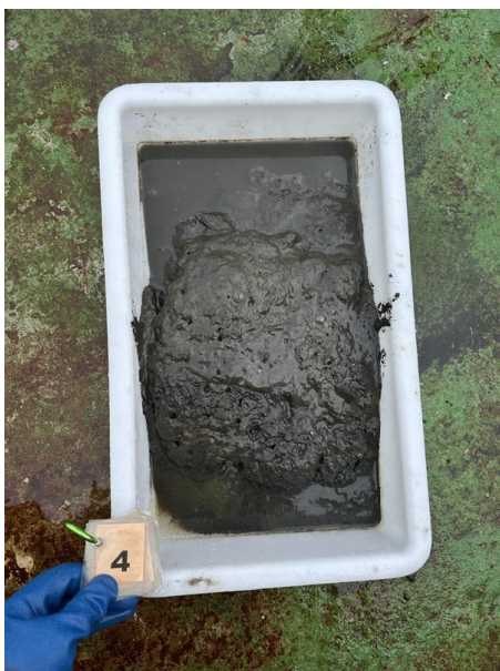
Figur 4: Bilde som viser substratet fra stasjon 4. Grabbinnhold ble ikke silt grunnet H_2S -gass Foto: Aqua Kompetanse AS.
