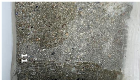
Figur B.11: Bilder før og etter siling ved stasjon 11. Sediment-/bunntype registrert som sand og skjellsand.
