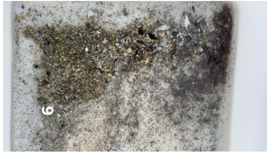
Figur B.9: Bilder før og etter siling ved stasjon 9. Sediment-/bunntype registrert som sand og skjellsand.
