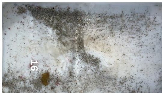
Figur B.16: Bilder før og etter siling ved stasjon 16. Sediment-/bunntype registrert som sand og skjellsand.
