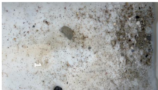
Figur B.1: Bilder før og etter siling ved stasjon 1. Sediment-/bunntype registrert som sand og skjellsand.
