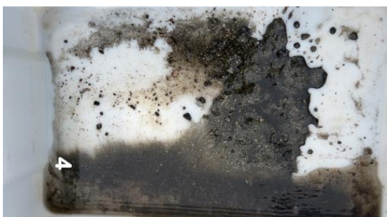
Figur B.4: Bilder før og etter siling ved stasjon 4. Sediment-/bunntype registrert som sand og skjellsand.
