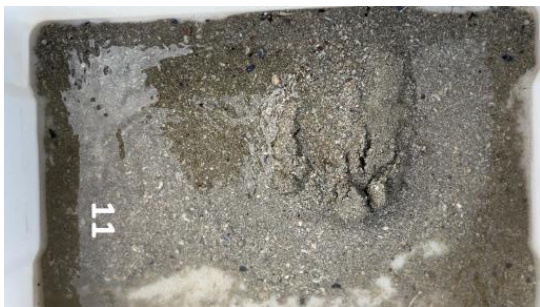
Figur B.11: Bilder før og etter siling ved stasjon 11. Sediment-/bunntype registrert som sand og skjellsand.
