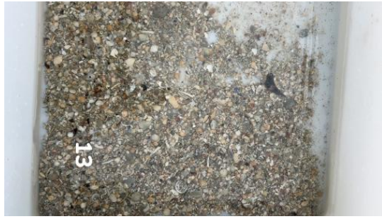
Figur B.13: Bilder før og etter siling ved stasjon 13. Sediment-/bunntype registrert som sand og skjellsand.
