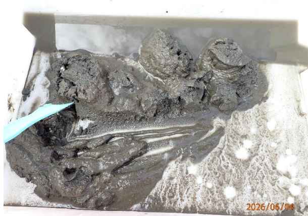
Prøvestasjon 8: Silt. Grå og luktfri prøve med fast konsistens.
