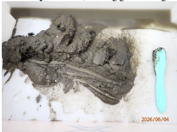
Prøvestasjon 11: Silt, sand og grus. Grå og luktfri prøve med fast konsistens.
