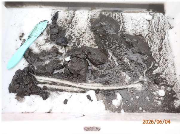
Prøvestasjon 10: Silt, sand og grus. Grå og luktfri prøve med fast konsistens.
