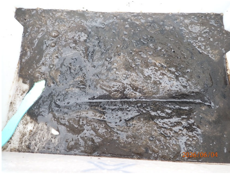
Prøvestasjon 12: Silt med fiskeskit. Brun farge, gass og sterk lukt i prøve med laus konsistens.
