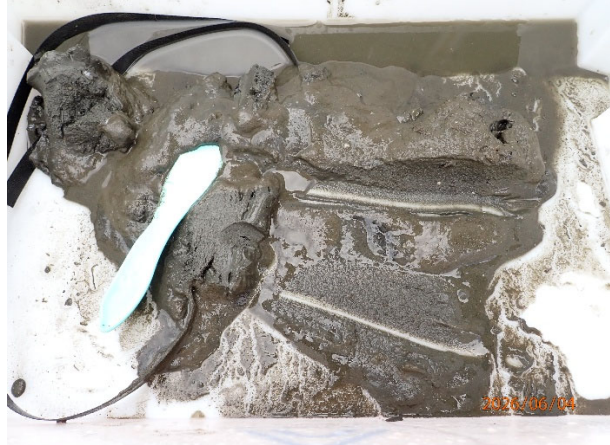
Prøvestasjon 7: Silt. Grå og luktfri prøve med fast konsistens.
