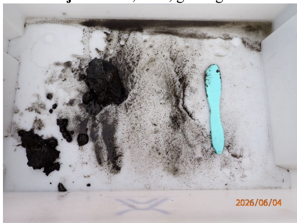
Prøvestasjon 9: Silt, sand, grus og stein. Grå og luktfri prøve med fast konsistens.
