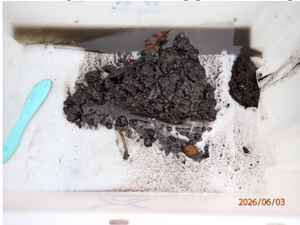
Prøvestasjon 4: Silt, sand og grus. Mørk farge men luktfri prøve med mjuk konsistens.
