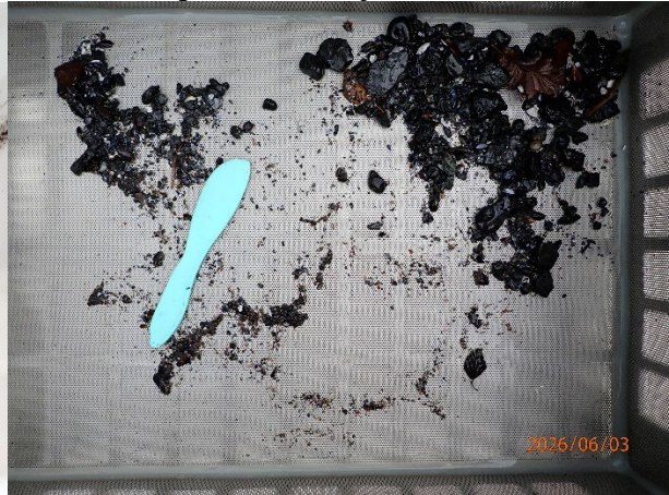
Prøvestasjon 4: Silt, sand og grus. Mørk farge men luktfri prøve med mjuk konsistens.
