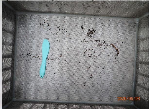
Prøvestasjon 8: Litt silt, sand og grus. Mørk farge men luktfri prøve med mjuk konsistens.
