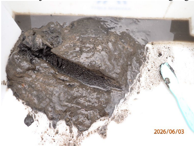
Prøvestasjon 6: Silt med fiske-skit. Brun farge og sterk lukt i prøve med laus konsistens.
