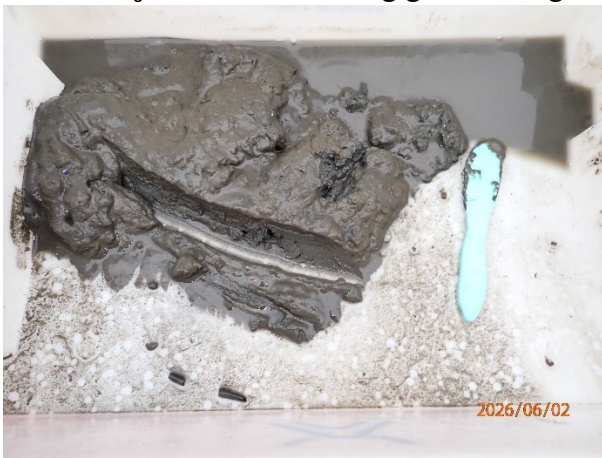
Prøvestasjon 14: Silt, sand og grus. Grå og luktfri prøve med fast konsistens.
