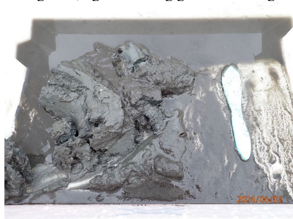
Prøvestasjon 6: Silt. Mørk farge og noko lukt i prøve med mjuk konsistens.
