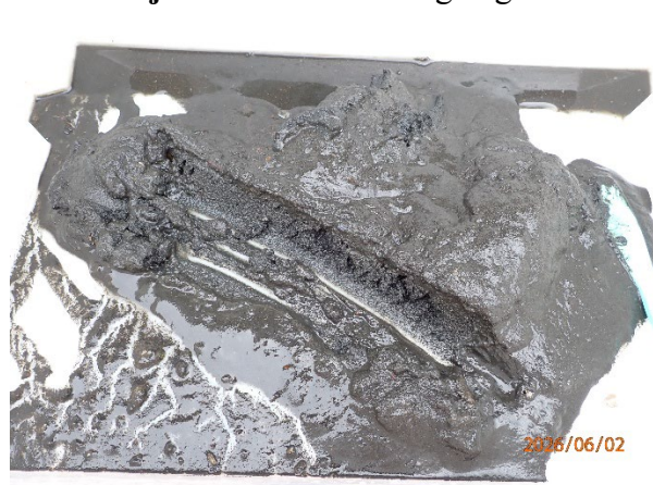
Prøvestasjon 6: Silt. Mørk farge og noko lukt i prøve med mjuk konsistens.
