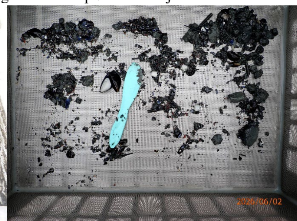
Prøvestasjon 6: Silt. Mørk farge og noko lukt i prøve med mjuk konsistens.
