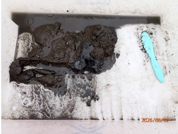
Prøvestasjon 13: Silt, leire, sand og grus. Mørk farge men luktfri prøve med mjuk konsistens.
