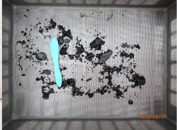
Prøvestasjon 13: Silt, leire, sand og grus. Mørk farge men luktfri prøve med mjuk konsistens.
