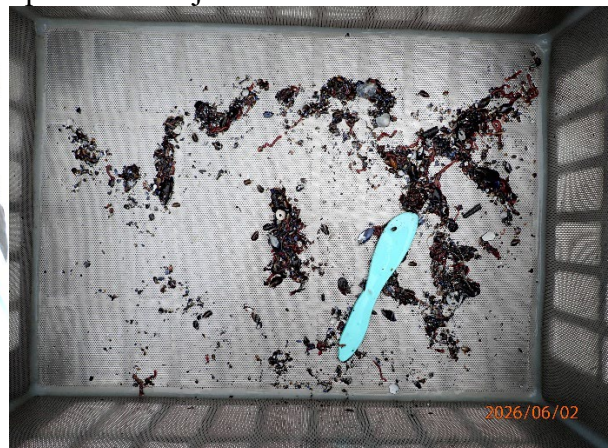
Prøvestasjon 6: Silt. Mørk farge og noko lukt i prøve med mjuk konsistens.
