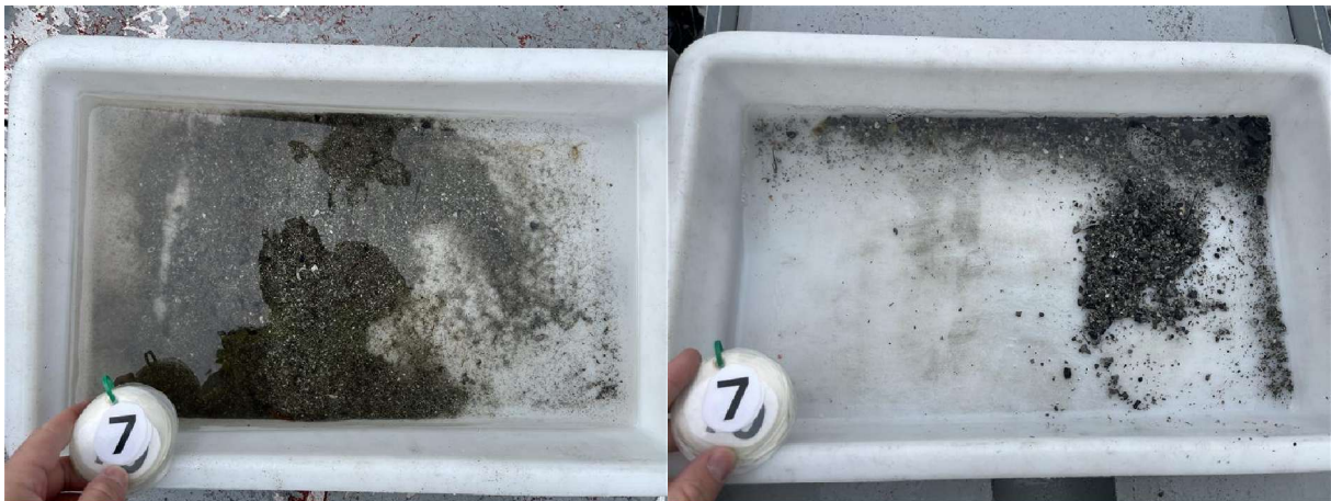
Figur 7: Bilder som viser substratet fra stasjon 7 før og etter siling. Foto: Aqua Kompetanse AS.
