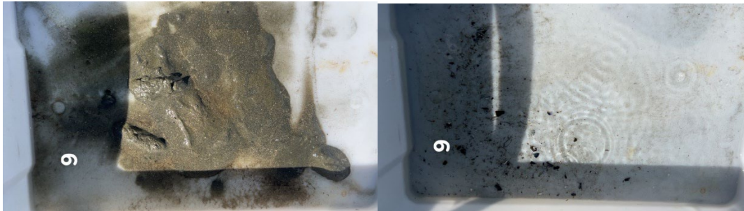
Figur B.6: Bilder før og etter siling ved stasjon 6. Sedimentet besto av sand.
