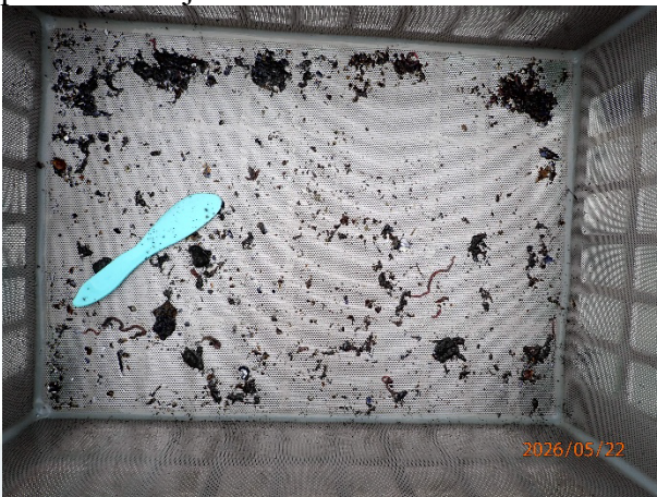
Prøvestasjon 14: Silt. Mørk farge men luktfri prøve med mjuk konsistens.
