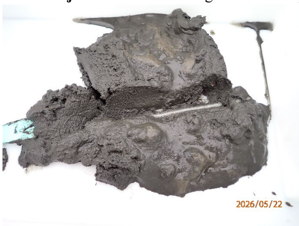
Prøvestasjon 14: Silt. Mørk farge men luktfri prøve med mjuk konsistens.
