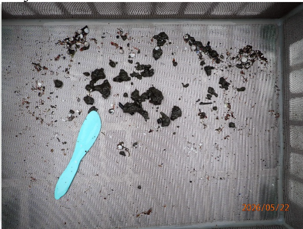
Prøvestasjon 15: Silt. Grå og luktfri prøve med mjuk konsistens.
