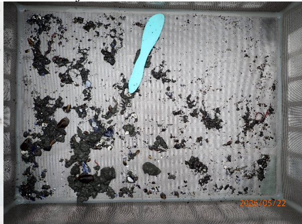
Prøvestasjon 9: Silt. Mørk farge men luktfri prøve med mjuk konsistens.
