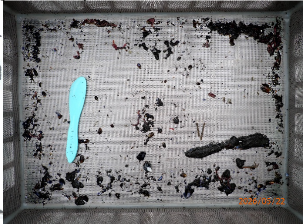
Prøvestasjon 10: Silt. Mørk farge men luktfri prøve med mjuk konsistens.
