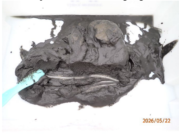
Prøvestasjon 12: Silt. Mørk farge og noko lukt i prøve med mjuk konsistens.
