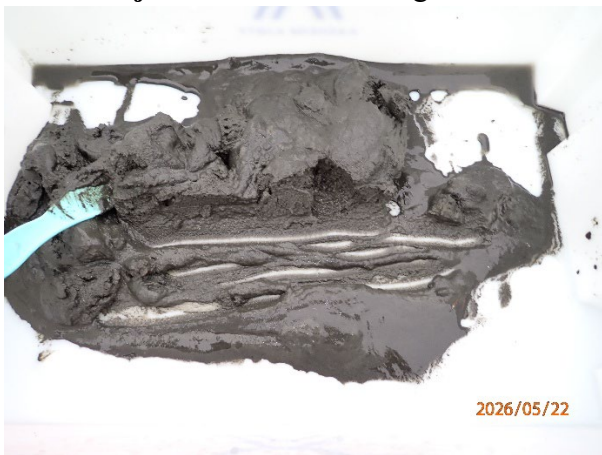
Prøvestasjon 11: Silt. Mørk farge men luktfri prøve med mjuk konsistens.
