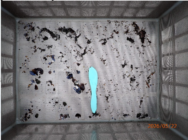
Prøvestasjon 11: Silt. Mørk farge men luktfri prøve med mjuk konsistens.
