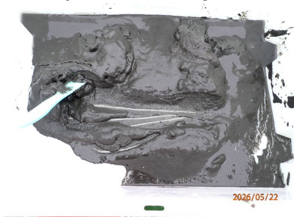
Prøvestasjon 13: Silt. Mørk farge men luktfri prøve med mjuk konsistens.
