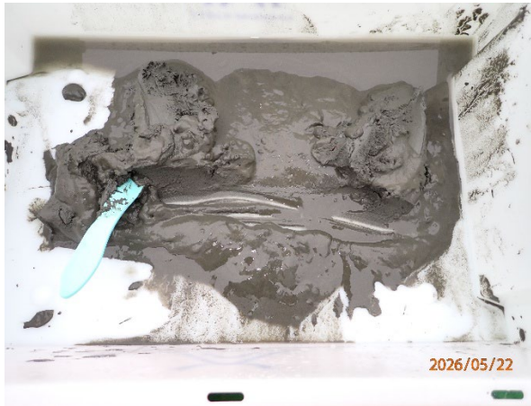
Prøvestasjon 7: Silt. Grå og luktfri prøve med mjuk konsistens.
