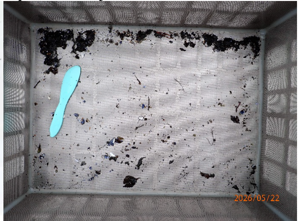
Prøvestasjon 12: Silt. Mørk farge og noko lukt i prøve med mjuk konsistens.
