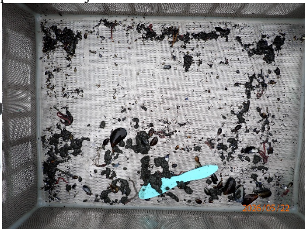
Prøvestasjon 13: Silt. Mørk farge men luktfri prøve med mjuk konsistens.
