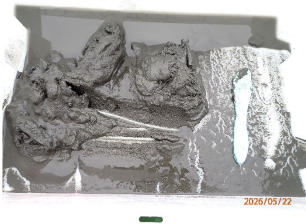
Prøvestasjon 8: Silt. Mørk farge men luktfri prøve med mjuk konsistens.
