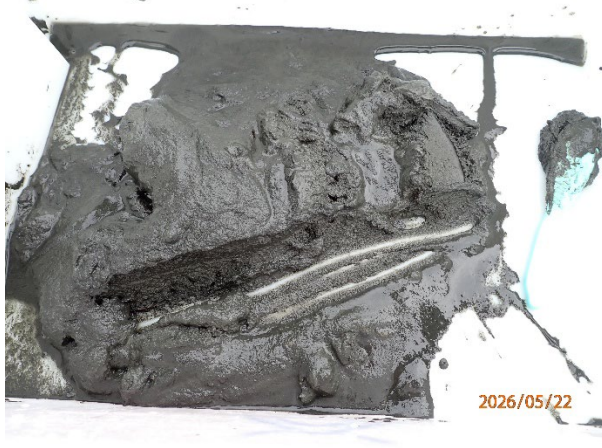
Prøvestasjon 10: Silt. Mørk farge men luktfri prøve med mjuk konsistens.
