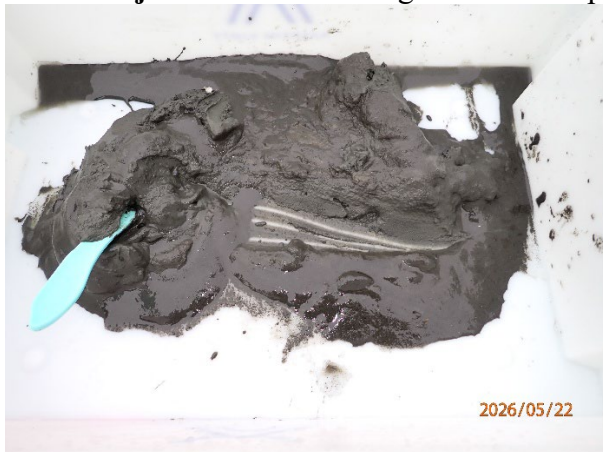
Prøvestasjon 9: Silt. Mørk farge men luktfri prøve med mjuk konsistens.
