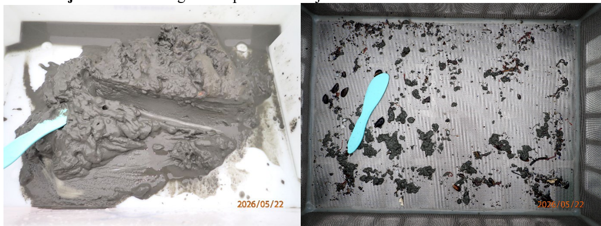
Prøvestasjon 5: Silt. Grå og luktfri prøve med mjuk konsistens.
