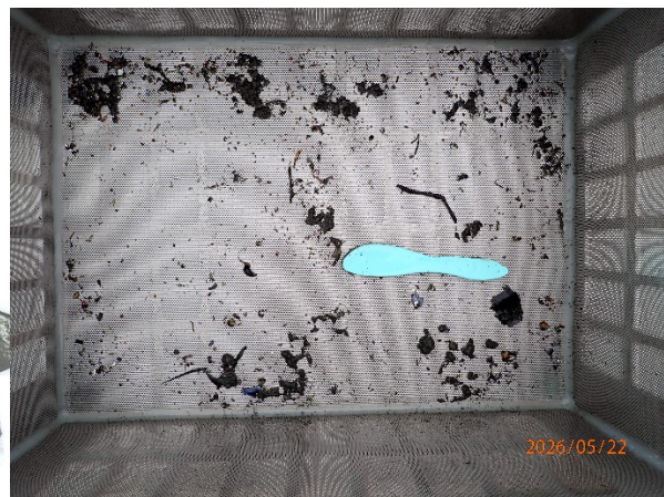
Prøvestasjon 8: Silt. Mørk farge men luktfri prøve med mjuk konsistens.
