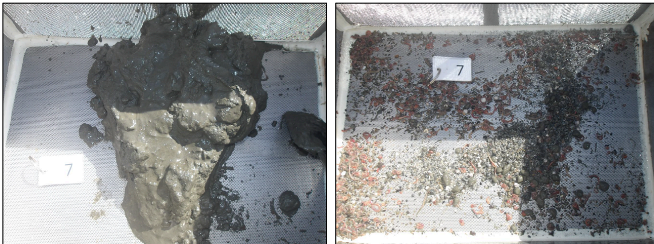
Figur 14. Bilder av sedimentet hentet opp fra prøvepunkt 7. Uvasket prøve til venstre og vasket/silt prøve til høyre.
