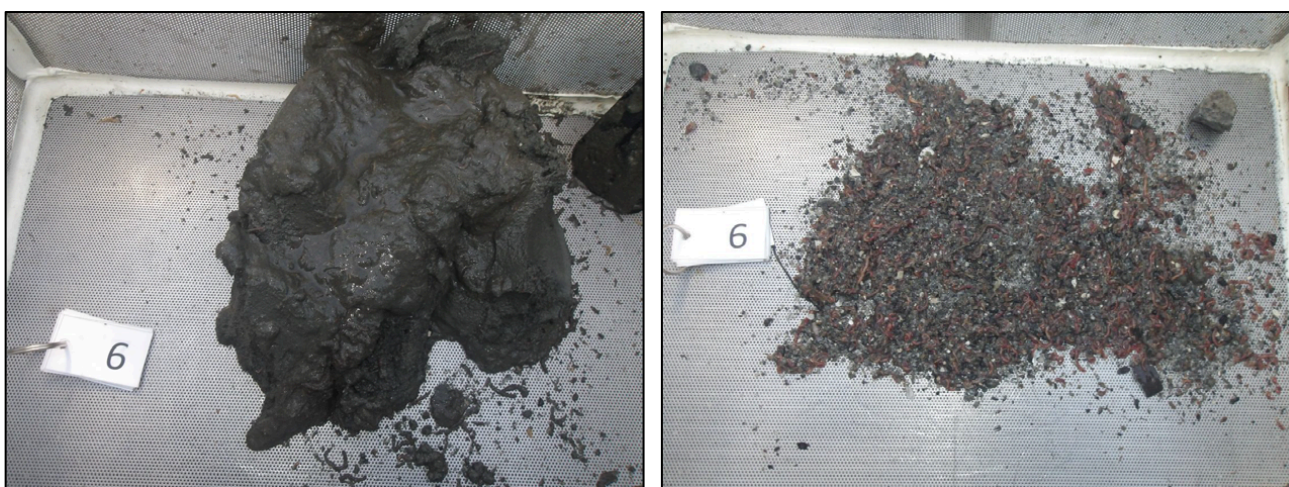
Figur 13. Bilder av sedimentet hentet opp fra prøvepunkt 6. Uvasket prøve til venstre og vasket/silt prøve til høyre.
