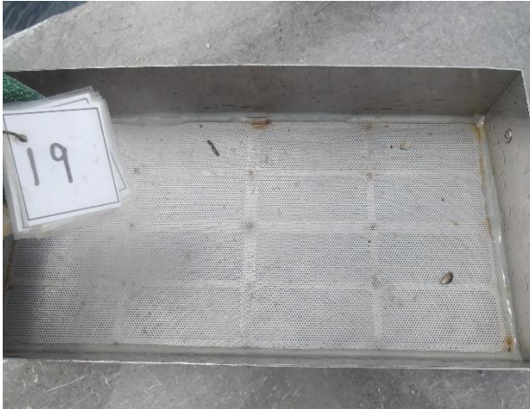
Ingen sediment å skylle
