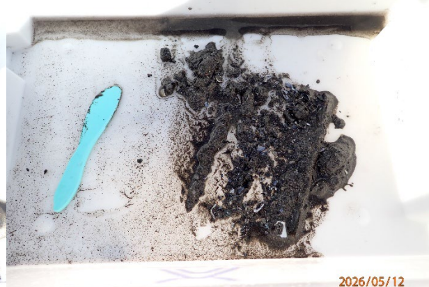
Prøvestasjon 4: Silt, og litt sand og grus. Grå og luktfri prøve med mjuk konsistens.
