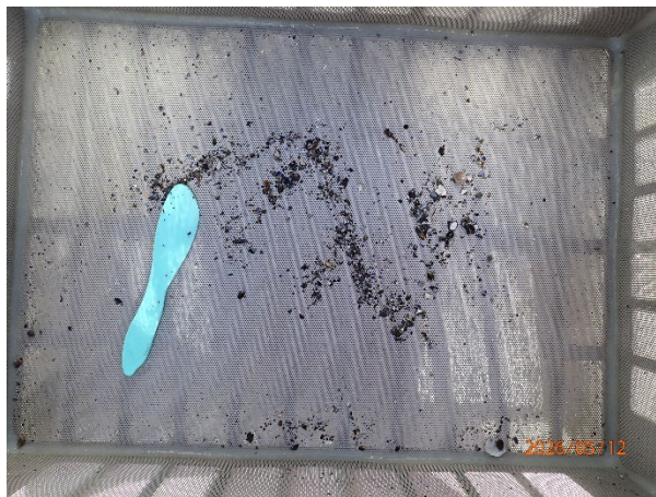
Prøvestasjon 5: Silt med litt fiske-skit. Mørk farge og noko lukt i prøve med mjuk konsistens.
