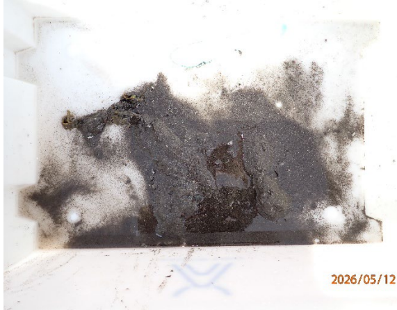
Prøvestasjon 9: Silt, sand og grus. Grå og luktfri prøve med mjuk konsistens.
