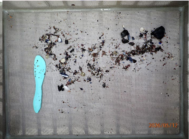
Prøvestasjon 10: Silt, sand og grus. Mørk farge og noko lukt i prøve med mjuk konsistens.
