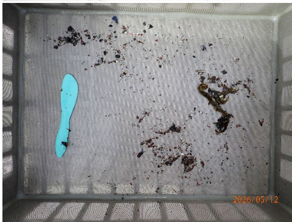
Prøvestasjon 10: Silt, sand og grus. Mørk farge og noko lukt i prøve med mjuk konsistens.
