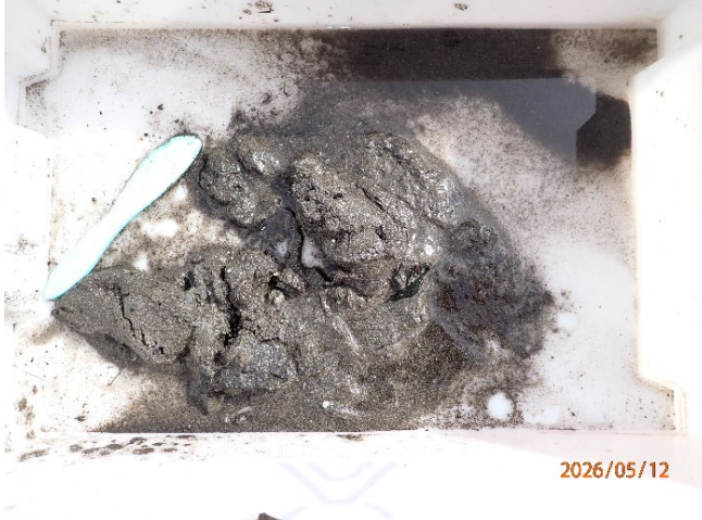
Prøvestasjon 10: Silt, sand og grus. Mørk farge og noko lukt i prøve med mjuk konsistens.
