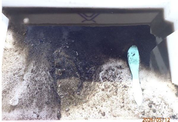
Prøvestasjon 4: Silt, og litt sand og grus. Grå og luktfri prøve med mjuk konsistens.
