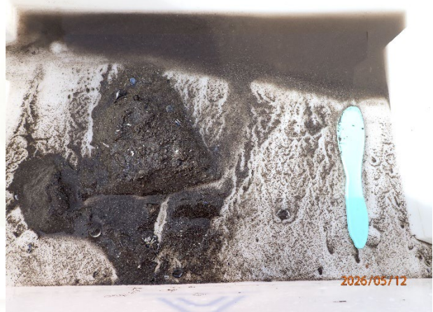
Prøvestasjon 9: Silt, sand og grus. Grå og luktfri prøve med mjuk konsistens.
