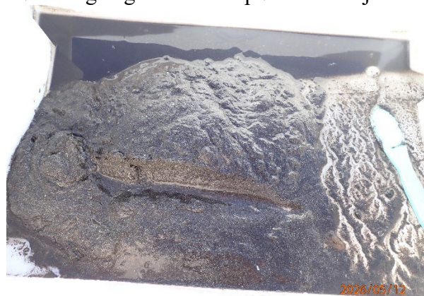
Prøvestasjon 5: Silt med litt fiske-skit. Mørk farge og noko lukt i prøve med mjuk konsistens.
