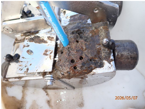
Prøvestasjon 5: Silt med fiske-skit. Brun farge, gass og sterk lukt i prøve med laus konsistens.
