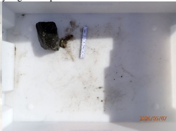
Prøvestasjon 8: Litt sand, grus og skjelsand. Lys og luktfri prøve med fast konsistens.
