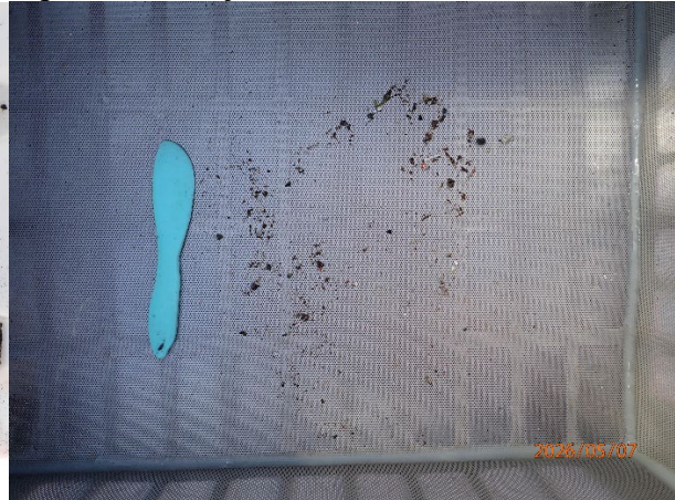
Prøvestasjon 9: Litt silt. Mørk farge men luktfri prøve med mjuk konsistens.
