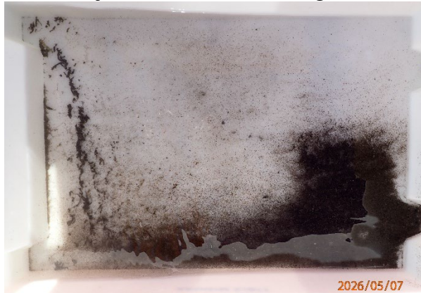
Prøvestasjon 9: Litt silt. Mørk farge men luktfri prøve med mjuk konsistens.
