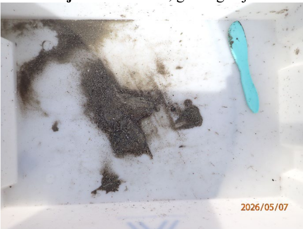
Prøvestasjon 8: Litt sand, grus og skjelsand. Lys og luktfri prøve med fast konsistens.
