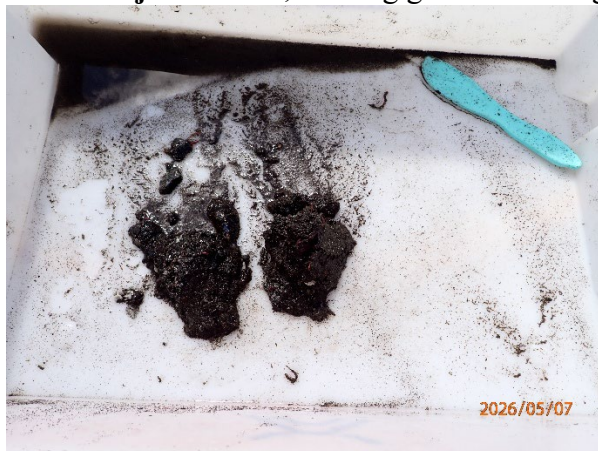
Prøvestasjon 10: Silt, sand og grus. Mørk farge men luktfri prøve med mjuk konsistens.
