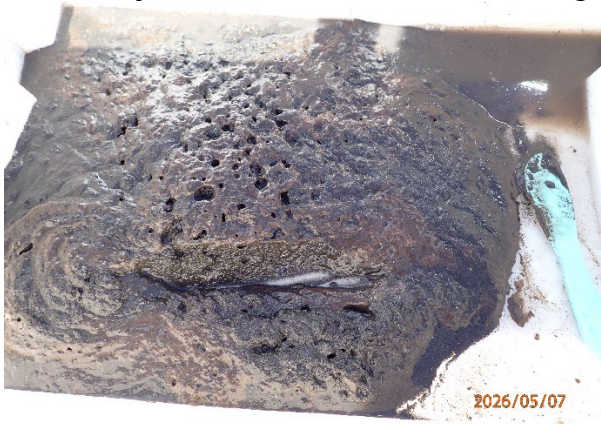
Prøvestasjon 6: Silt med fiske-skit. Brun farge, gass og sterk lukt i prøve med laus konsistens.
