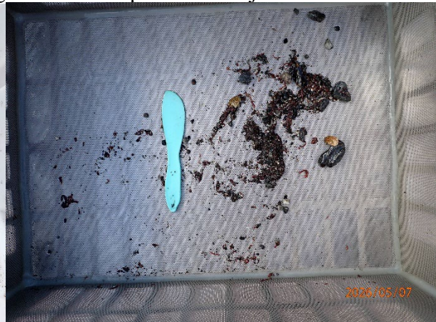
Prøvestasjon 10: Silt, sand og grus. Mørk farge men luktfri prøve med mjuk konsistens.
