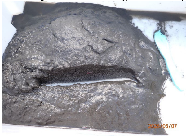
Prøvestasjon 7: Silt. Mørk farge men luktfri prøve med mjuk konsistens.
