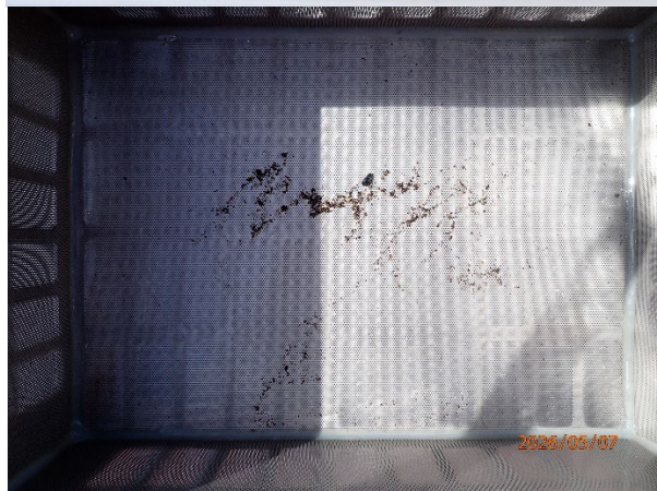
Prøvestasjon 12: Silt, sand, grus og skjelsand. Mørk farge men luktfri prøve med mjuk konsistens.
