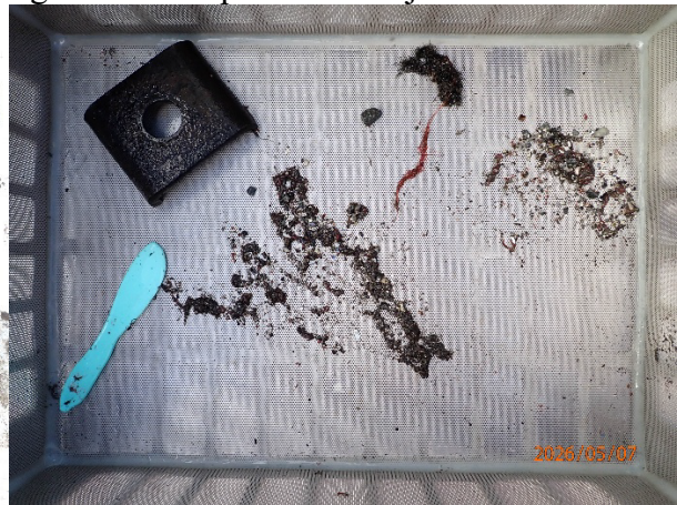
Prøvestasjon 5: Silt med fiske-skit. Brun farge, gass og sterk lukt i prøve med laus konsistens.
