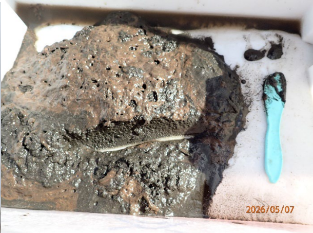
Prøvestasjon 5: Silt med fiske-skit. Brun farge, gass og sterk lukt i prøve med laus konsistens.
