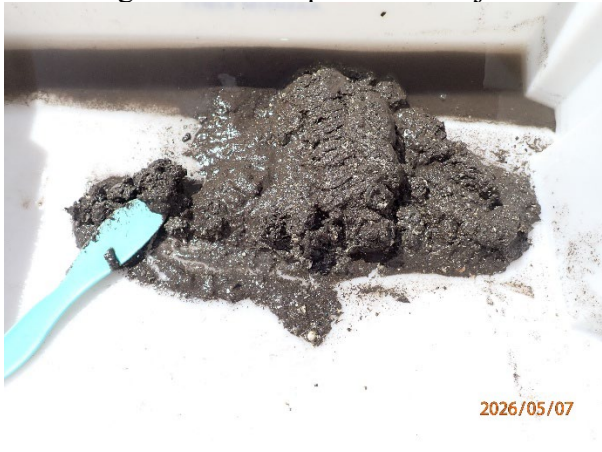
Prøvestasjon 12: Silt, sand, grus og skjelsand. Mørk farge men luktfri prøve med mjuk konsistens.
