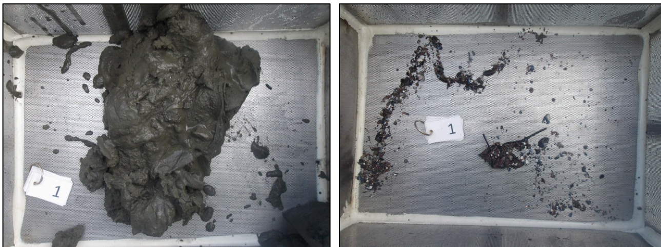
Figur 7. Bilder av sedimentet hentet opp fra prøvepunkt 1. Uvasket prøve til venstre og vasket/silt prøve til høyre.
