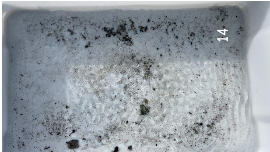
Figur B.14: Bilde fra prøven ved stasjon 14. Sedimentet besto av strø av grus på fjellbunn. Det ble registrert fekalier i denne prøven.
