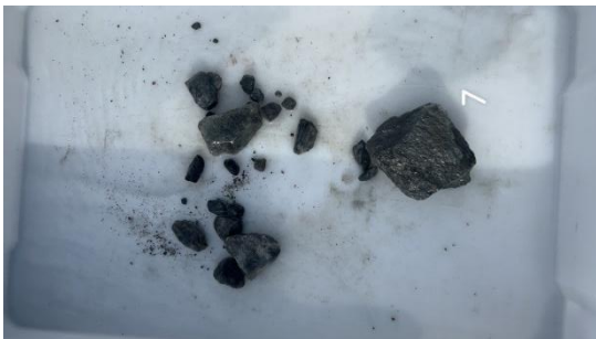
Figur B.7: Bilde fra prøven ved stasjon 7. Sedimentet er fraværende på grunn av steinbunn.
