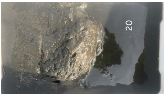
Figur B.20: Bilder før og etter siling ved stasjon 20. Sedimentet besto av silt og sand.
