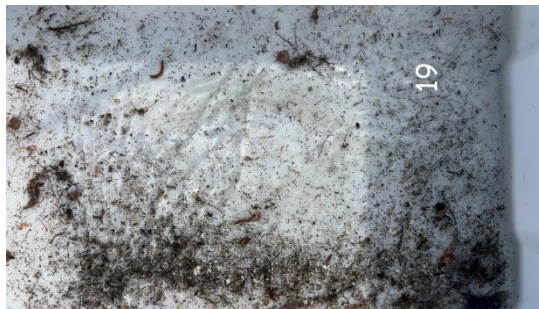
Figur B.19: Bilder før og etter siling ved stasjon 19. Sedimentet besto av silt og sand.
