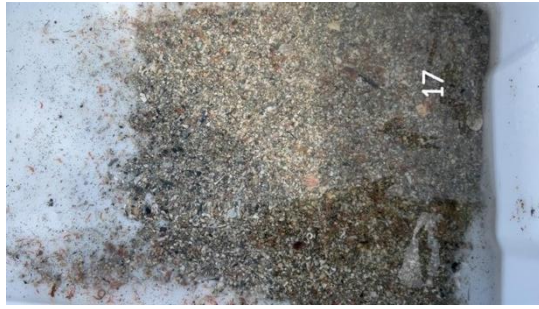
Figur B.17: Bilder før og etter siling ved stasjon 17. Sedimentet besto av silt og sand.
