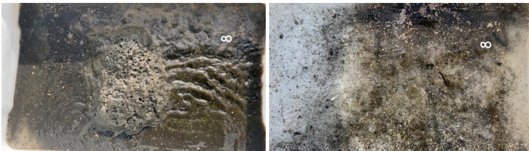
Figur B.8: Bilder før og etter siling ved stasjon 8. Sedimentet besto av sand og skjellsand. Det ble registrert fôrrester i denne prøven.
