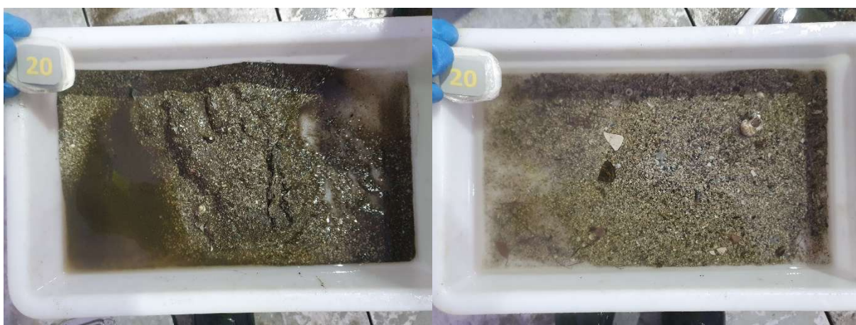
Figur 20: Bilder som viser sedimentet fra stasjon 20 før og etter siling. Sedimentet besto av silt, sand og skjellsand. Foto: Aqua Kompetanse AS.
