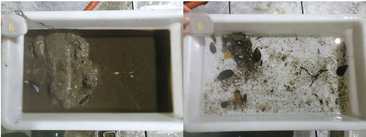
Figur 6: Bilder som viser sedimentet fra stasjon 6 før og etter siling. Sedimentet besto av silt, sand og skjellsand. Foto: Aqua Kompetanse AS.
