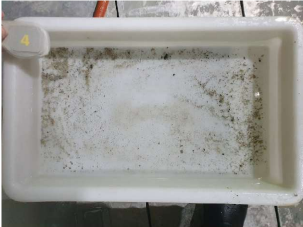
Figur 4: Bilde som viser sedimentet fra stasjon 4. Sedimentet besto av strø av sand på fjellbunn. Foto: Aqua Kompetanse AS.
