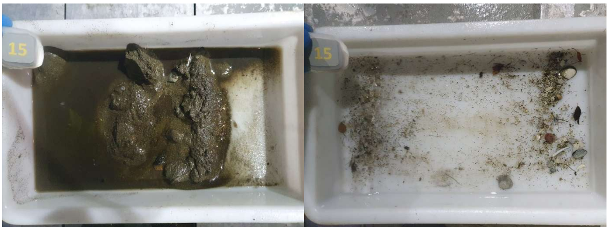
Figur 15: Bilder som viser sedimentet fra stasjon 15 før og etter siling. Sedimentet besto av silt, sand og skjellsand. Det ble registrert fekalier i denne prøven. Foto: Aqua Kompetanse AS.
