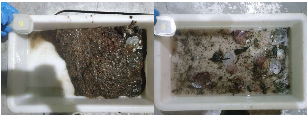
Figur 9: Bilder som viser sedimentet fra stasjon 9 før og etter siling. Sedimentet besto av silt, sand og grus. Det ble registrert fôr og fekalier i denne prøven. Foto: Aqua Kompetanse AS.
