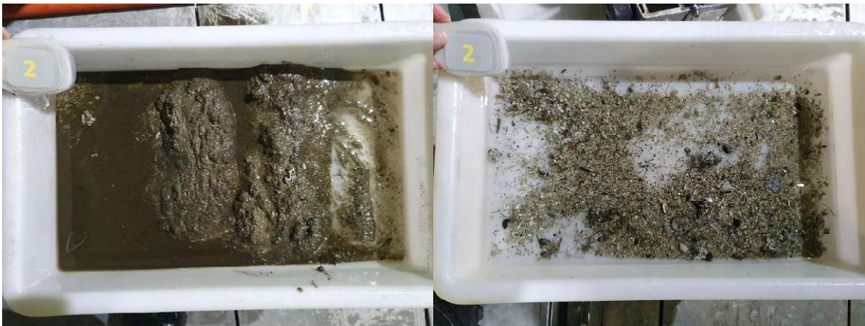
Figur 2: Bilder som viser sedimentet fra stasjon 2 før og etter siling. Sedimentet besto av sand, skjellsand, og silt. Foto: Aqua Kompetanse AS.
