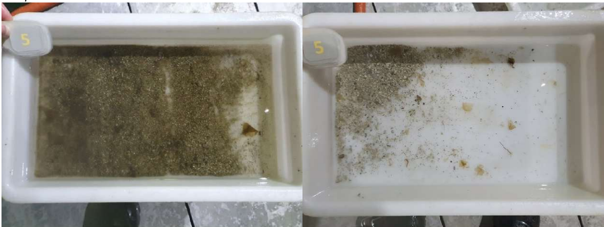
Figur 5: Bilder som viser sedimentet fra stasjon 5 før og etter siling. Sedimentet besto av sand og skjellsand på fjellbunn. Foto: Aqua Kompetanse AS.
