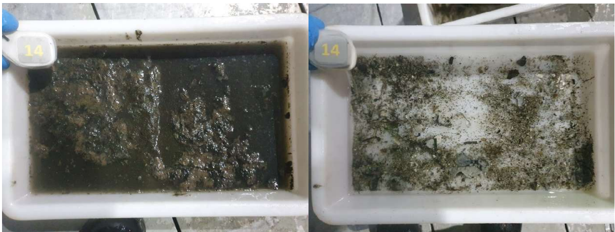
Figur 14: Bilder som viser sedimentet fra stasjon 14 før og etter siling. Sedimentet besto av silt, sand og skjellsand. Foto: Aqua Kompetanse AS.
