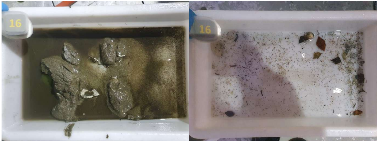
Figur 16: Bilder som viser sedimentet fra stasjon 16 før og etter siling. Sedimentet besto av silt og sand. Foto: Aqua Kompetanse AS.
