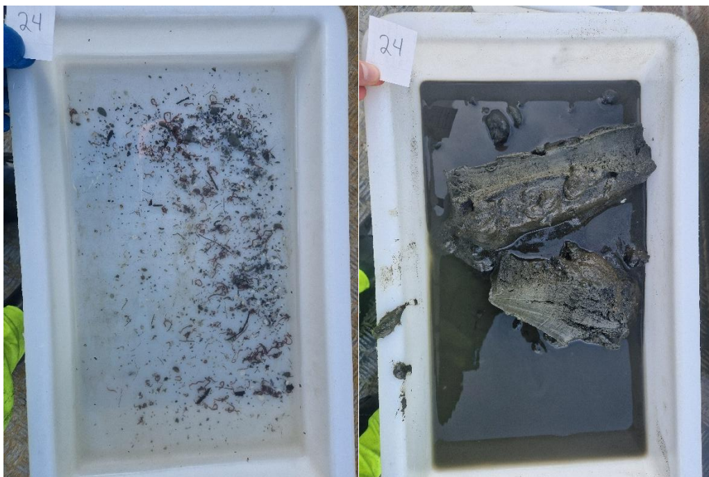
Figur 24: Bilder som viser sedimentet fra stasjon 24 før og etter siling. Foto: Aqua Kompetanse AS.
