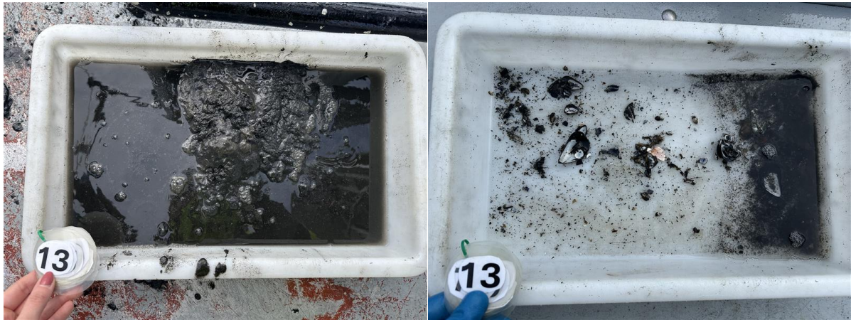
Figur 13: Bilder som viser sedimentet fra stasjon 13 før og etter siling. Foto: Aqua Kompetanse AS.
