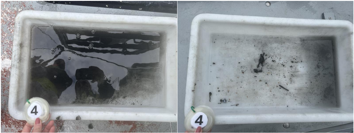
Figur 4: Bilder som viser sedimentet fra stasjon 4 før og etter siling. Foto: Aqua Kompetanse AS.
