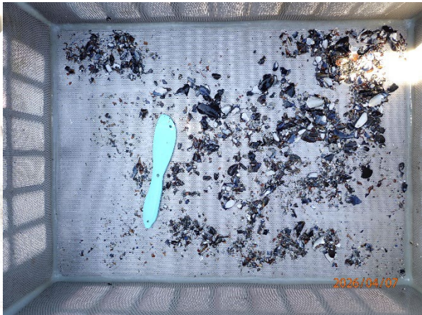
Prøvestasjon 7: Silt, sand og grus. Grå og luktfri prøve med mjuk konsistens.
