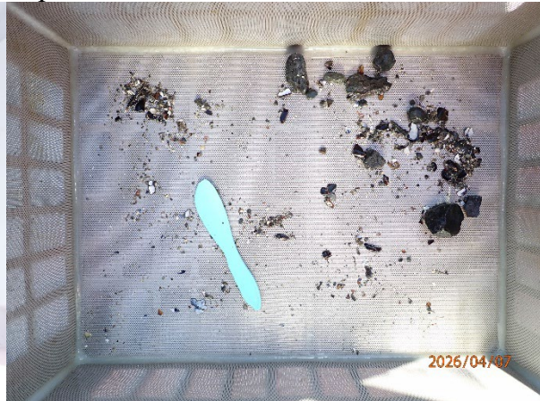
Prøvestasjon 8: Silt, sand og grus. Grå og luktfri prøve med fast konsistens.
