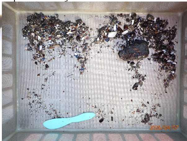
Prøvestasjon 9: Silt, sand og grus. Grå og luktfri prøve med mjuk konsistens.
