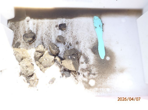
Prøvestasjon 8: Silt, sand og grus. Grå og luktfri prøve med fast konsistens.
