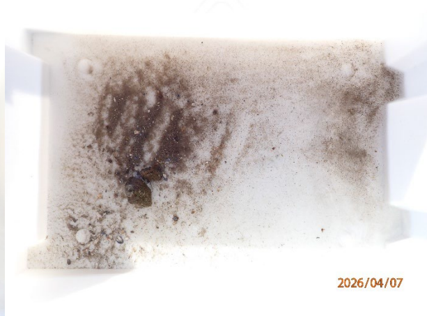
Prøvestasjon 5: Litt silt, sand og grus. Grå og luktfri prøve med fast konsistens.
