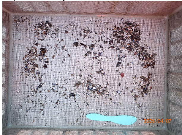
Prøvestasjon 4: Silt, sand og grus. Grå og luktfri prøve med mjuk konsistens.
