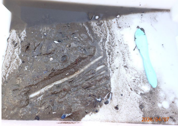
Prøvestasjon 13: Silt, sand og grus. Grå og luktfri prøve med mjuk konsistens.
