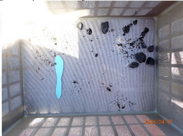
Prøvestasjon 14: Litt silt, sand og grus. Grå og luktfri prøve med mjuk konsistens.
