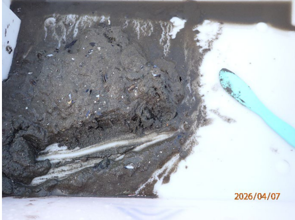
Prøvestasjon 12: Silt, sand og grus. Grå og luktfri prøve med mjuk konsistens.
