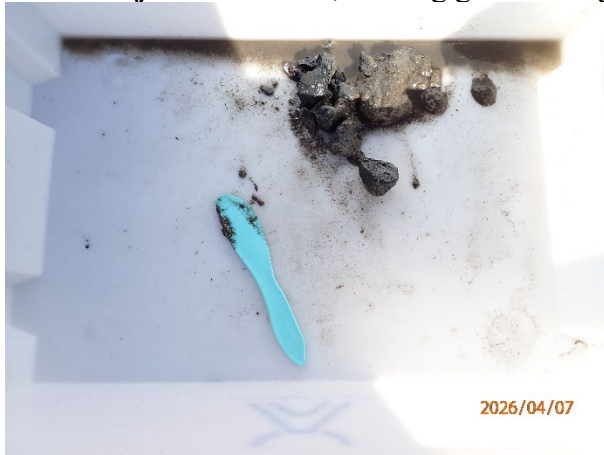
Prøvestasjon 14: Litt silt, sand og grus. Grå og luktfri prøve med mjuk konsistens.
