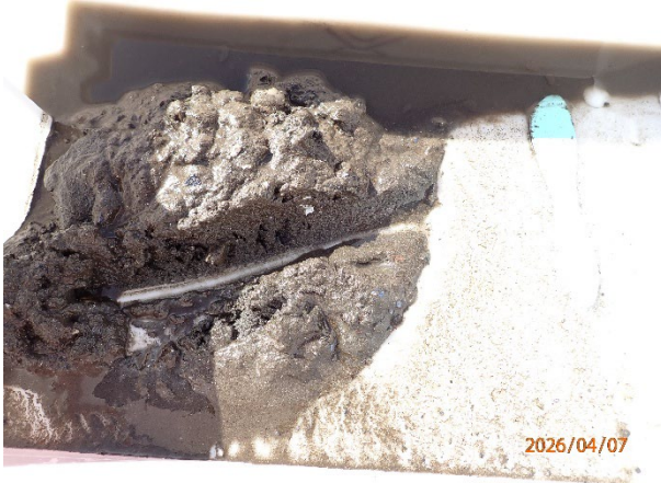
Prøvestasjon 9: Silt, sand og grus. Grå og luktfri prøve med mjuk konsistens.
