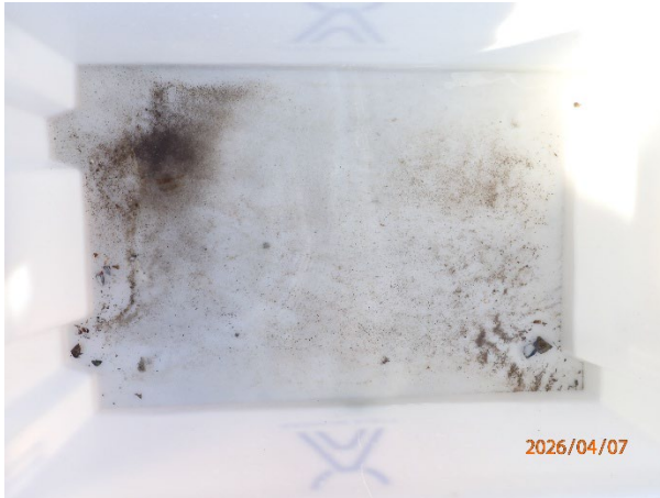
Prøvestasjon 5: Litt silt, sand og grus. Grå og luktfri prøve med fast konsistens.
