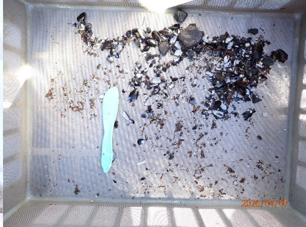
Prøvestasjon 13: Silt, sand og grus. Grå og luktfri prøve med mjuk konsistens.
