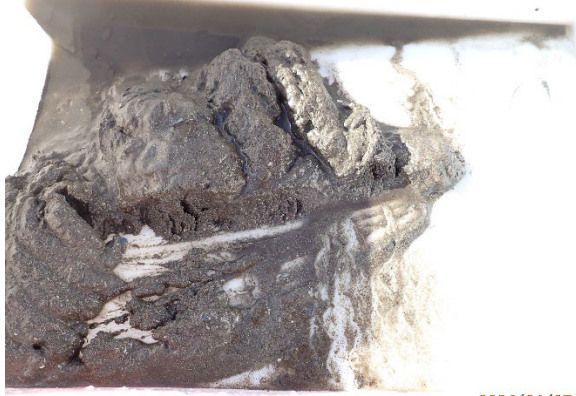
Prøvestasjon 4: Silt, sand og grus. Grå og luktfri prøve med mjuk konsistens.
