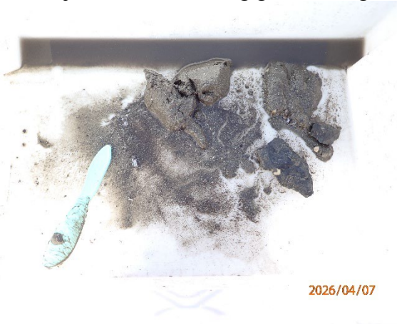
Prøvestasjon 10: Silt, sand og grus. Grå og luktfri prøve med fast konsistens.
