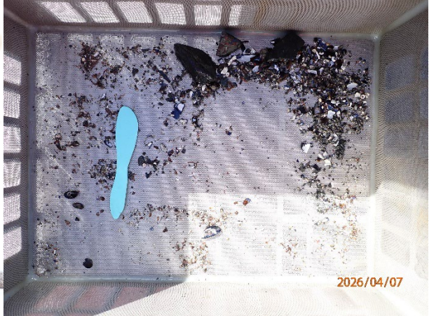
Prøvestasjon 11: Silt, sand og grus. Grå og luktfri prøve med mjuk konsistens.
