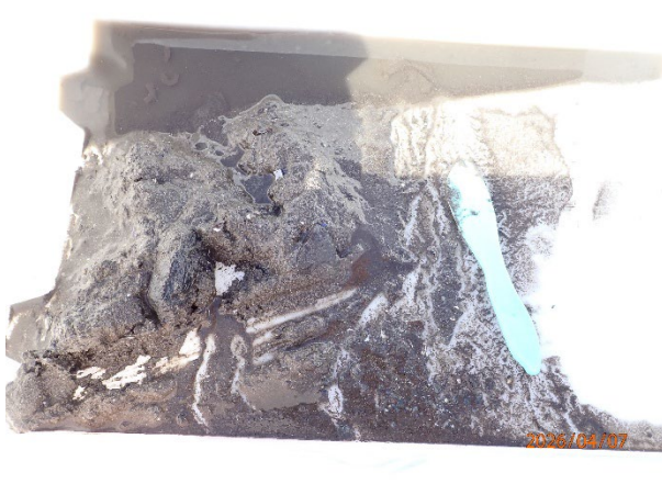
Prøvestasjon 11: Silt, sand og grus. Grå og luktfri prøve med mjuk konsistens.
