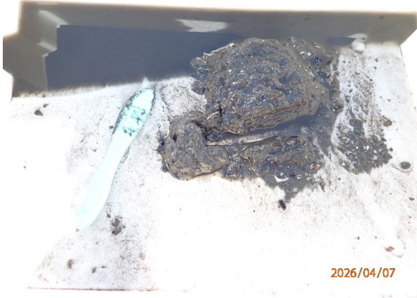
Prøvestasjon 7: Silt, sand og grus. Grå og luktfri prøve med mjuk konsistens.
