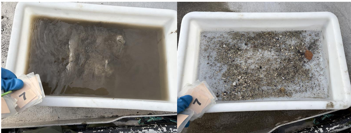
Figur 7: Bilder som viser substratet fra stasjon 7 før og etter siling. Foto: Aqua Kompetanse AS.
