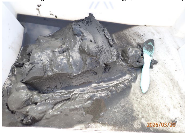
Prøvestasjon 4: Silt. Mørk farge, noko lukt i prøve med mjuk konsistens.
