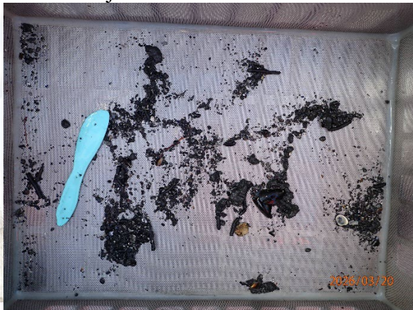
Prøvestasjon 4: Silt. Mørk farge, noko lukt i prøve med mjuk konsistens.
