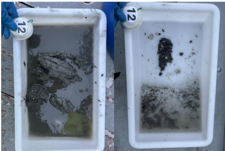
Figur 12: Bilder som viser sedimentet fra stasjon 12 før og etter siling. Sedimentet besto av leire og silt. Foto: Aqua Kompetanse AS.
