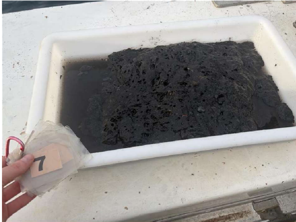
Figur 7: Bilde som viser sedimentet fra stasjon 7. Siling ble ikke utført grunnet gass. Foto: Aqua Kompetanse AS.
