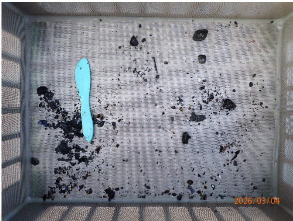
Prøvestasjon 12: Silt, sand og grus. Mørk farge men luktfri prøve med mjuk konsistens.
