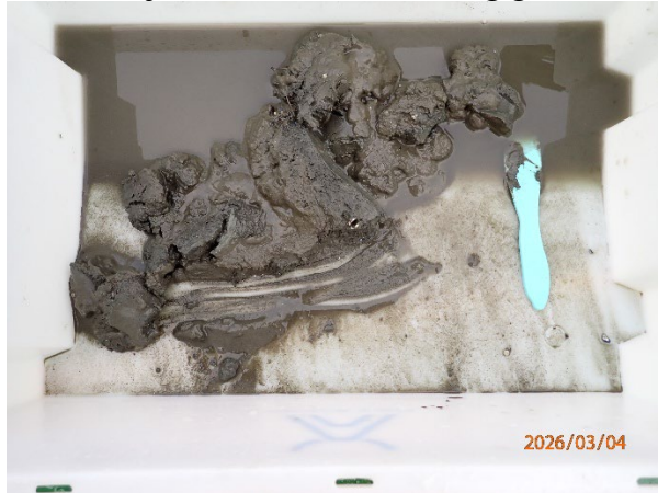
Prøvestasjon 7: Leire, silt, sand og grus. Grå og luktfri prøve med fast konsistens.
