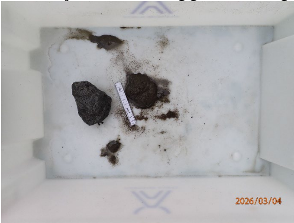
Prøvestasjon 8: Silt, sand og grus. Mørk farge og noko lukt i prøve med mjuk konsistens.
