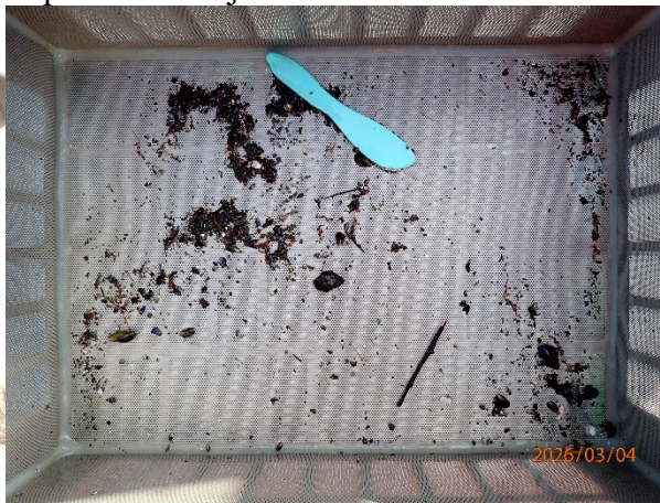
Prøvestasjon 13: Silt. Mørk farge og noko lukt i prøve med mjuk konsistens.
