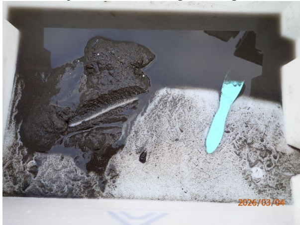
Prøvestasjon 4: Silt. Grå og luktfri prøve med mjuk konsistens.
