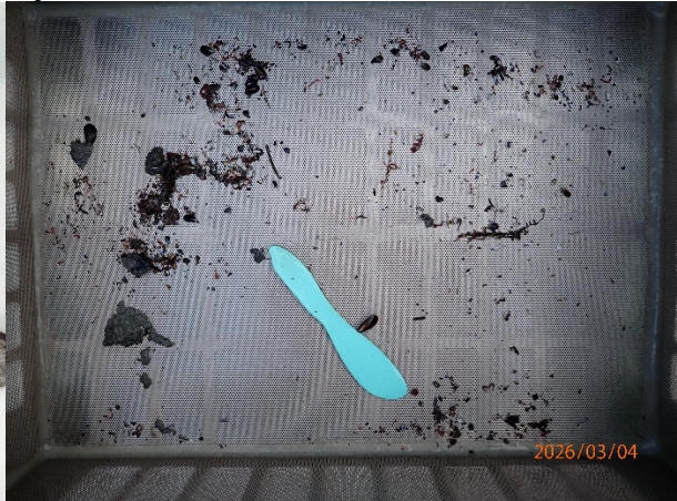
Prøvestasjon 4: Silt. Grå og luktfri prøve med mjuk konsistens.
