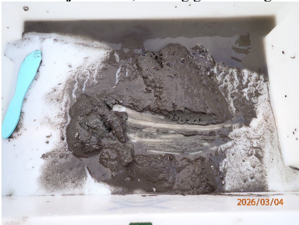
Prøvestasjon 5: Silt, sand og grus. Grå og luktfri prøve med fast konsistens.
