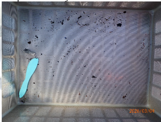
Prøvestasjon 14: Silt, sand og grus. Grå og luktfri prøve med mjuk konsistens.
