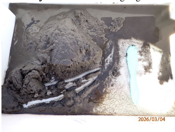
Prøvestasjon 13: Silt. Mørk farge og noko lukt i prøve med mjuk konsistens.
