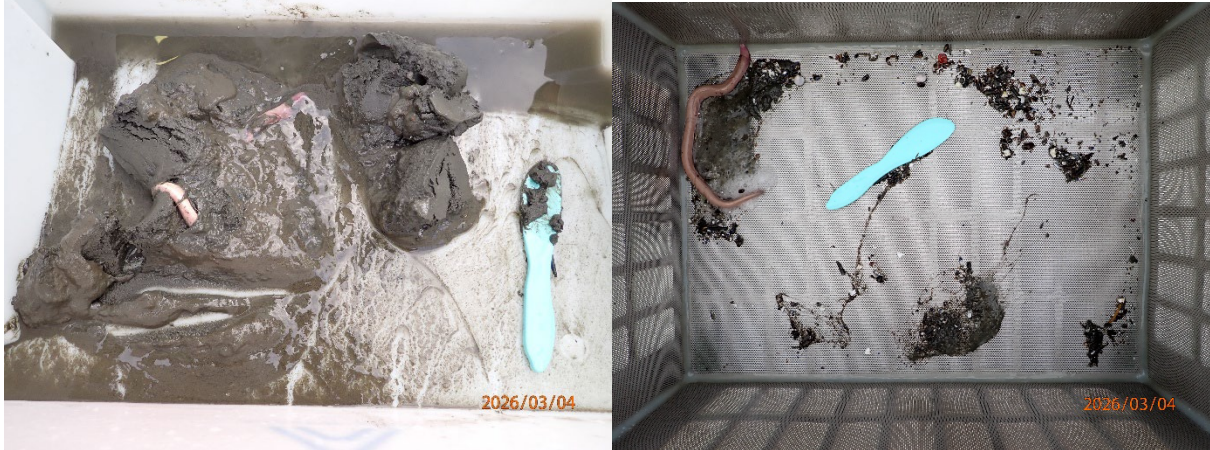
Prøvestasjon 9: Silt. Grå og luktfri prøve med mjuk konsistens.
