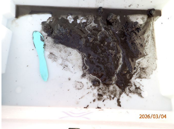
Prøvestasjon 12: Silt, sand og grus. Mørk farge men luktfri prøve med mjuk konsistens.
