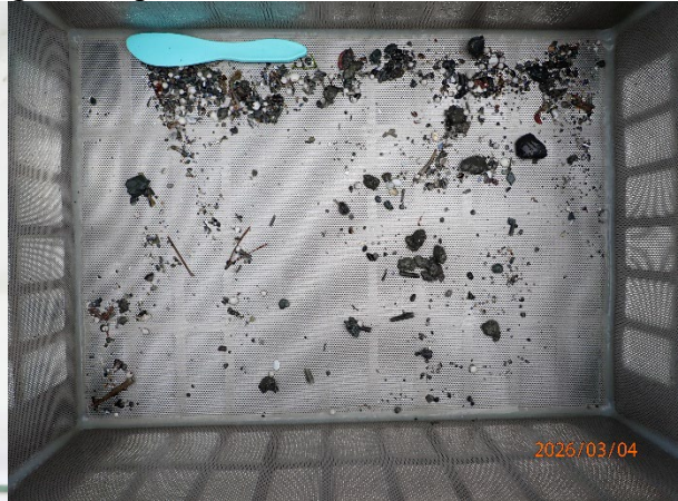
Prøvestasjon 7: Leire, silt, sand og grus. Grå og luktfri prøve med fast konsistens.
