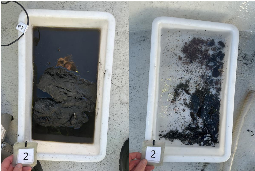
Figur 2: Bilder som viser sedimentet fra stasjon 2 før og etter siling. Sedimentet besto av silt, sand og grus. Foto: Aqua Kompetanse AS.
