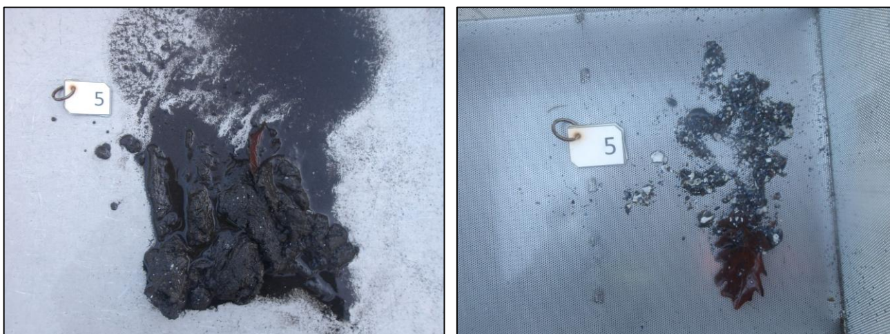
Figur 11. Bilder av sedimentet hentet opp fra prøvepunkt 5. Uvasket prøve til venstre og vasket/silt prøve til høyre.
