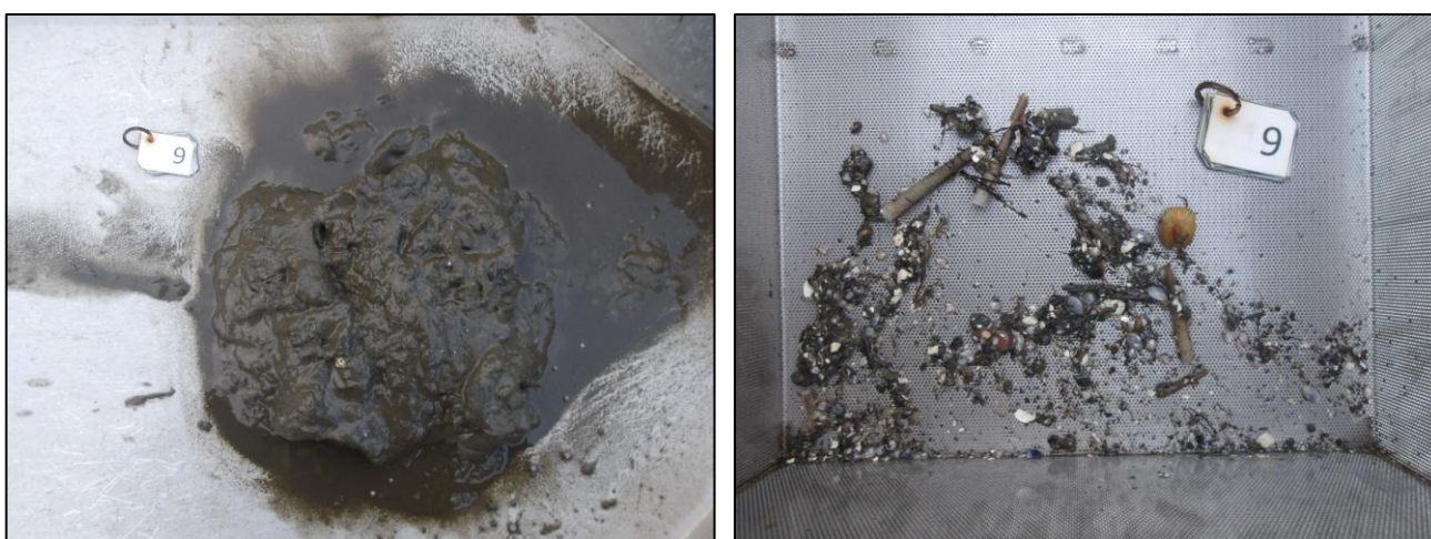
Figur 15. Bilder av sedimentet hentet opp fra prøvepunkt 9. Uvasket prøve til venstre og vasket/silt prøve til høyre.
