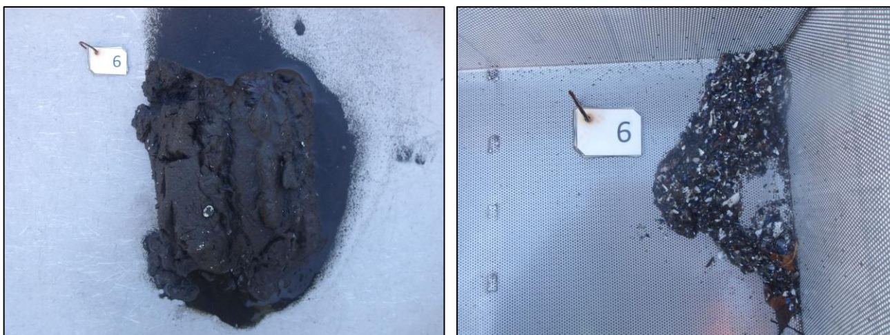
Figur 12. Bilder av sedimentet hentet opp fra prøvepunkt 6. Uvasket prøve til venstre og vasket/silt prøve til høyre.
