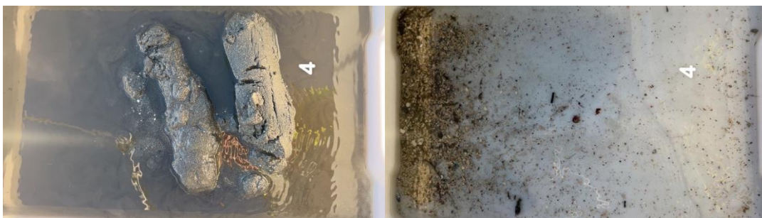
Figur B.4: Bilder før og etter siling ved stasjon 4. Sedimentet besto av sand, silt og skjellsand.
