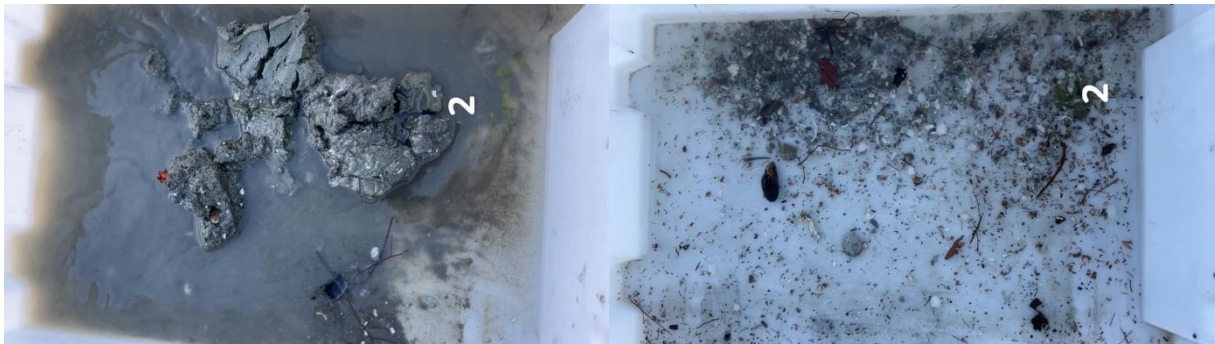
Figur B.2: Bilder før og etter siling ved stasjon 2. Sedimentet besto av leire og silt.
