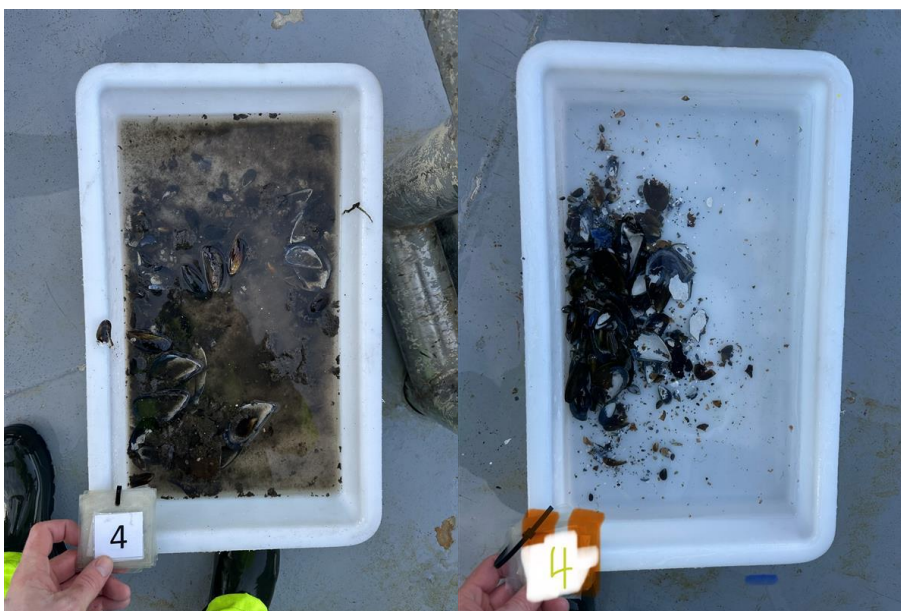
Figur 4: Bilder som viser sedimentet fra stasjon 4 før og etter siling. Sedimentet besto av silt. Det ble også registrert fjellbunn. Det ble også registrert fôrrester i prøven. Foto: Aqua Kompetanse AS.
