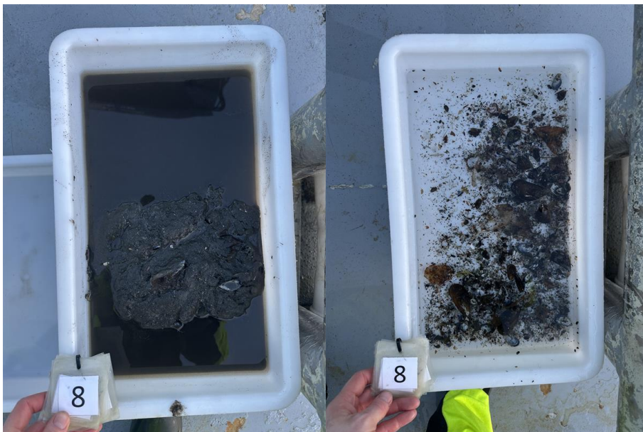
Figur 8: Bilder som viser sedimentet fra stasjon 8 før og etter siling. Sedimentet besto av silt. Foto: Aqua Kompetanse AS.
