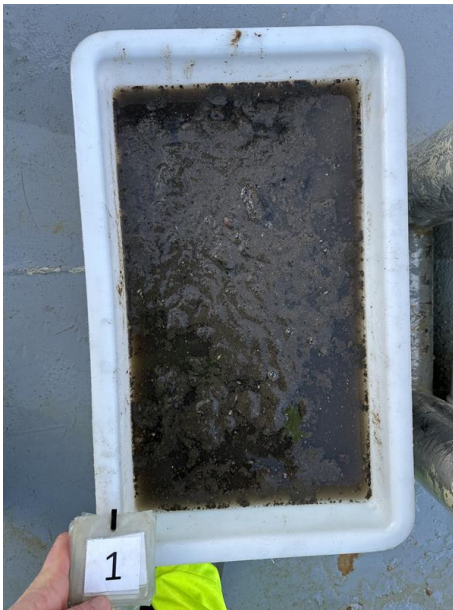
Figur 1: Bilde som viser sedimentet fra stasjon 1. Prøven ble ikke spylt grunnet lukt. Sedimentet besto av silt. Det ble observert bobling ved prøvetaking. Det ble registrert fôrrester og fekalier i prøven. Foto: Aqua Kompetanse AS.
