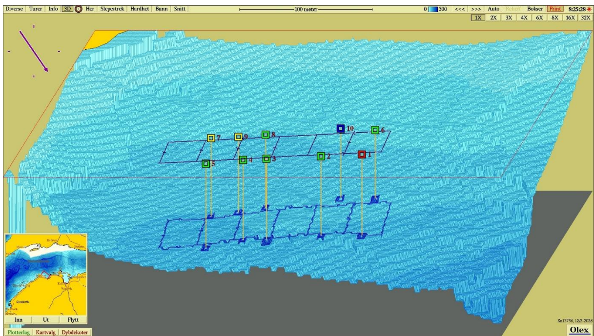
Figur 3: Tredimensjonalt isometrisk bunnkart med anleggssomriss og stasjoner. Stasjonene er markert med farge etter hva slags tilstand de har jamført NS 9410:2016. Målestokk vises øverst i bildet. Kartdatum WGS84. Kilde: Olex.
