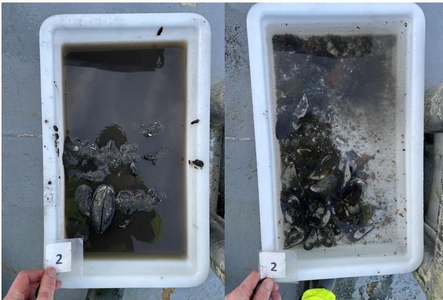
Figur 2: Bilder som viser sedimentet fra stasjon 2 før og etter siling. Sedimentet besto av silt og skjellsand. Det ble registrert fekalier i prøven. Foto: Aqua Kompetanse AS.
