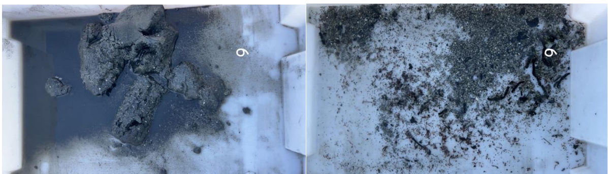
Figur B.8: Bilder før og etter siling ved stasjon 9. Sedimentet bestod av sand og silt
