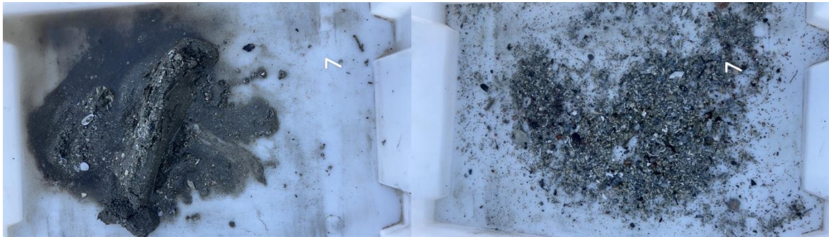
Figur B.6: Bilder før og etter siling ved stasjon 7. Sedimentet bestod av grus og sand.
