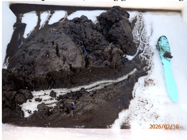
Prøvestasjon 9: Silt, sand og grus. Mørk farge og noko lukt i prøve med mjuk konsistens.
