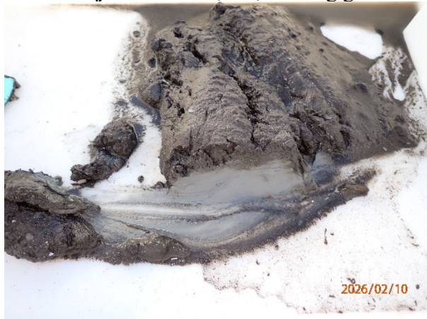
Prøvestasjon 10: Leire, silt, sand og grus. Grå og luktfri prøve med fast konsistens.
