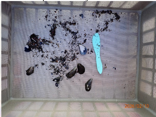
Prøvestasjon 7: Silt, sand og grus. Mørk farge men luktfri prøve med mjuk konsistens.
