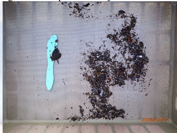
Prøvestasjon 9: Silt, sand og grus. Mørk farge og noko lukt i prøve med mjuk konsistens.
