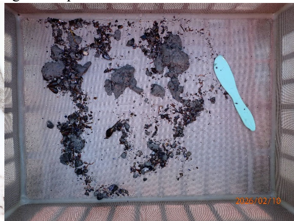
Prøvestasjon 10: Leire, silt, sand og grus. Grå og luktfri prøve med fast konsistens.
