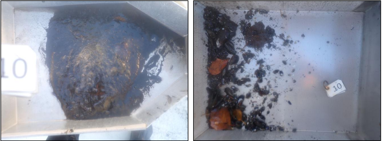
Figur 16. Bilder av sedimentet hentet opp fra prøvepunkt 10. Uvasket prøve til venstre og vasket/silt prøve til høyre.
