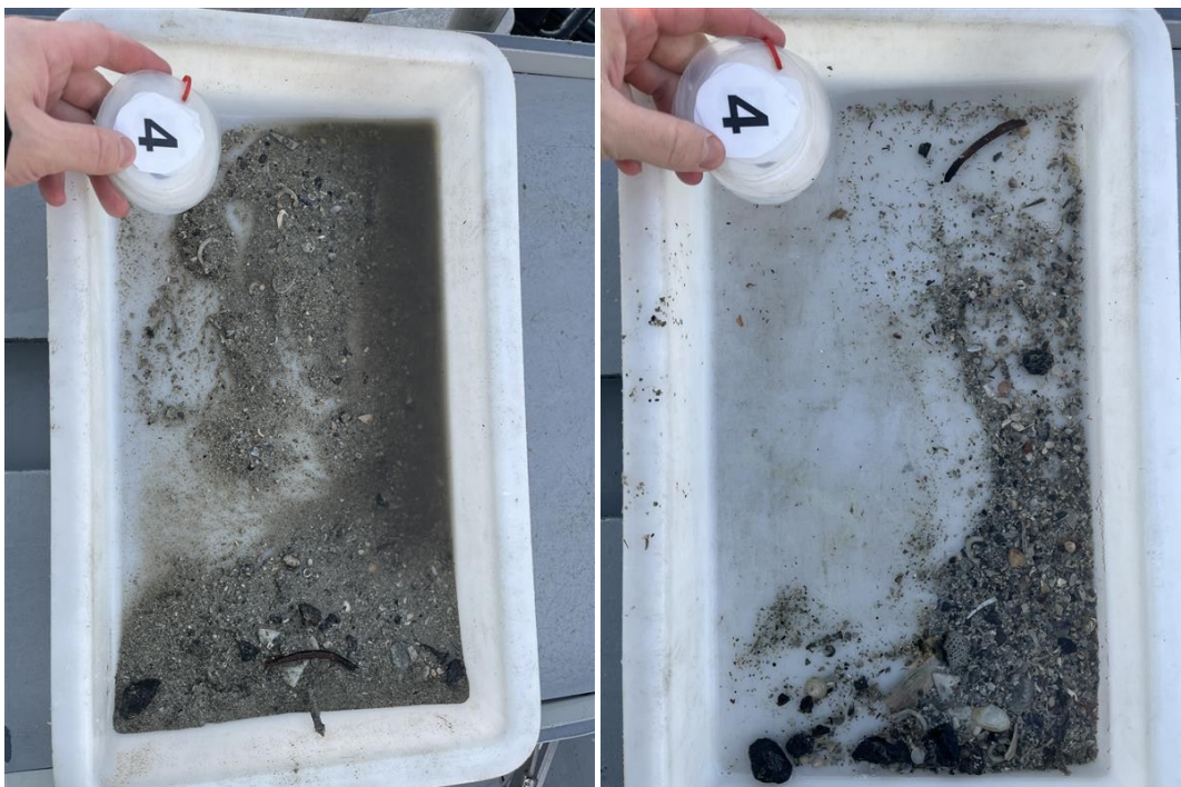
Figur 4: Bilder som viser sedimentet fra stasjon 4 før og etter siling. Sedimentet besto av silt, sand, grus og skjellsand. Foto: Aqua Kompetanse AS.
