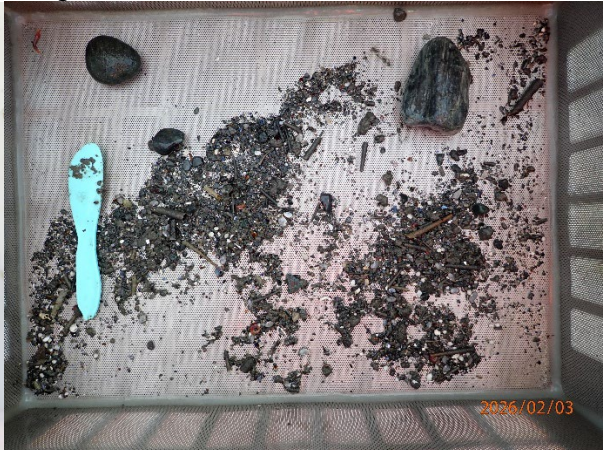
Prøvestasjon 13: Silt, sand og grus. Grå og luktfri prøve med fast konsistens.
