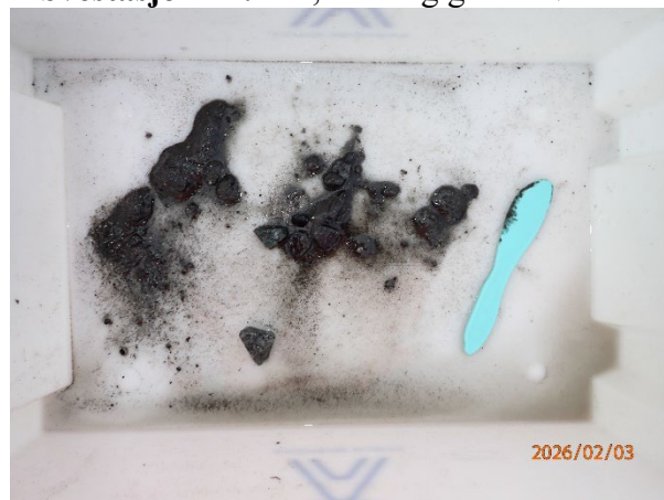
Prøvestasjon 11: Silt, sand og grus. Mørk men luktfri prøve med mjuk konsistens.
