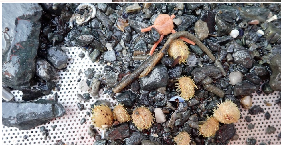
Prøvestasjon 5: Silt, sand og grus. Grå og luktfri prøve med fast konsistens.
