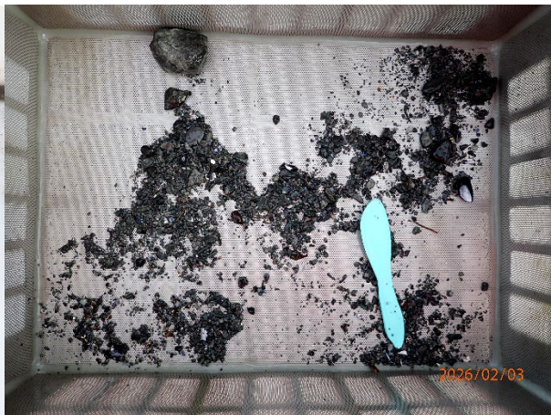
Prøvestasjon 11: Silt, sand og grus. Mørk men luktfri prøve med mjuk konsistens.
