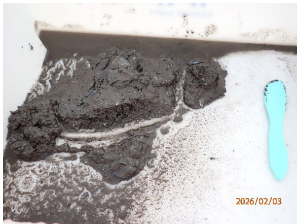
Prøvestasjon 11: Silt, sand og grus. Mørk men luktfri prøve med mjuk konsistens.
