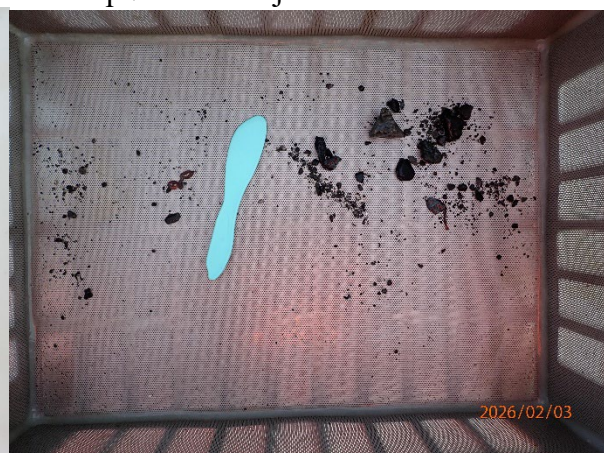
Prøvestasjon 11: Silt, sand og grus. Mørk men luktfri prøve med mjuk konsistens.
