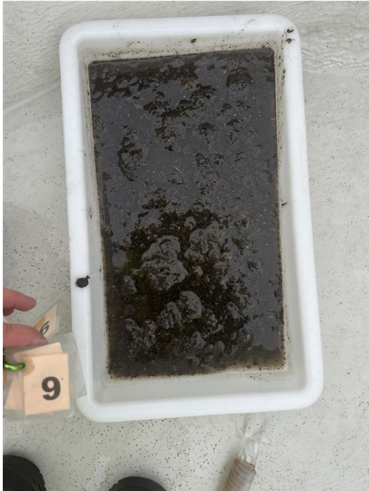
Figur 9: Bilde som viser sedimentet fra stasjon 9. Prøven ble ikke spylt pga. H_2S -gass. Sedimentet besto av silt. Det ble registrert rester av fôr ved stasjonen. Foto: Aqua Kompetanse AS.
