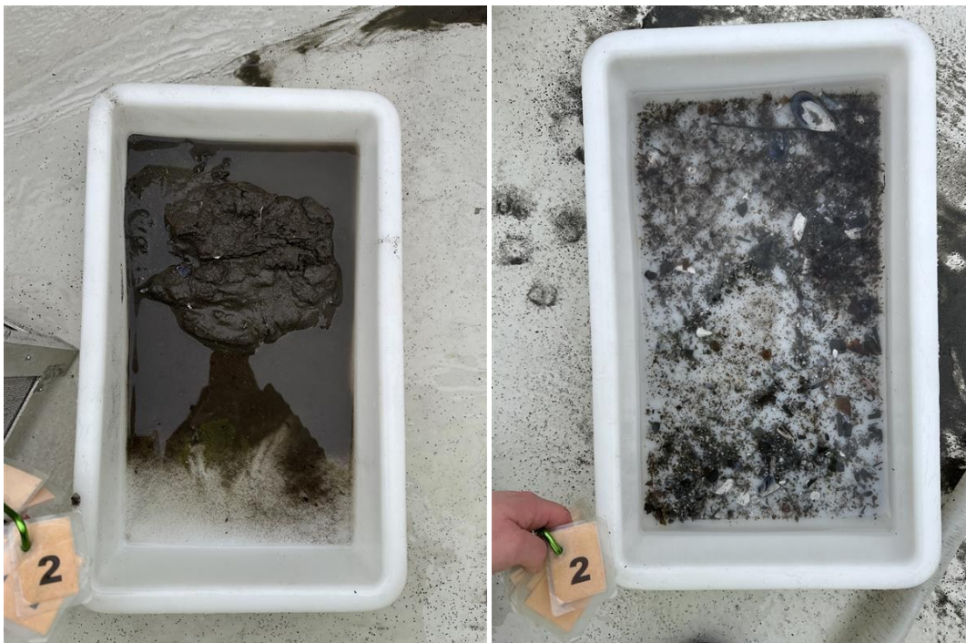
Figur 2: Bilder som viser sedimentet fra stasjon 2 før og etter siling. Sedimentet besto av silt og sand. Foto: Aqua Kompetanse AS.
