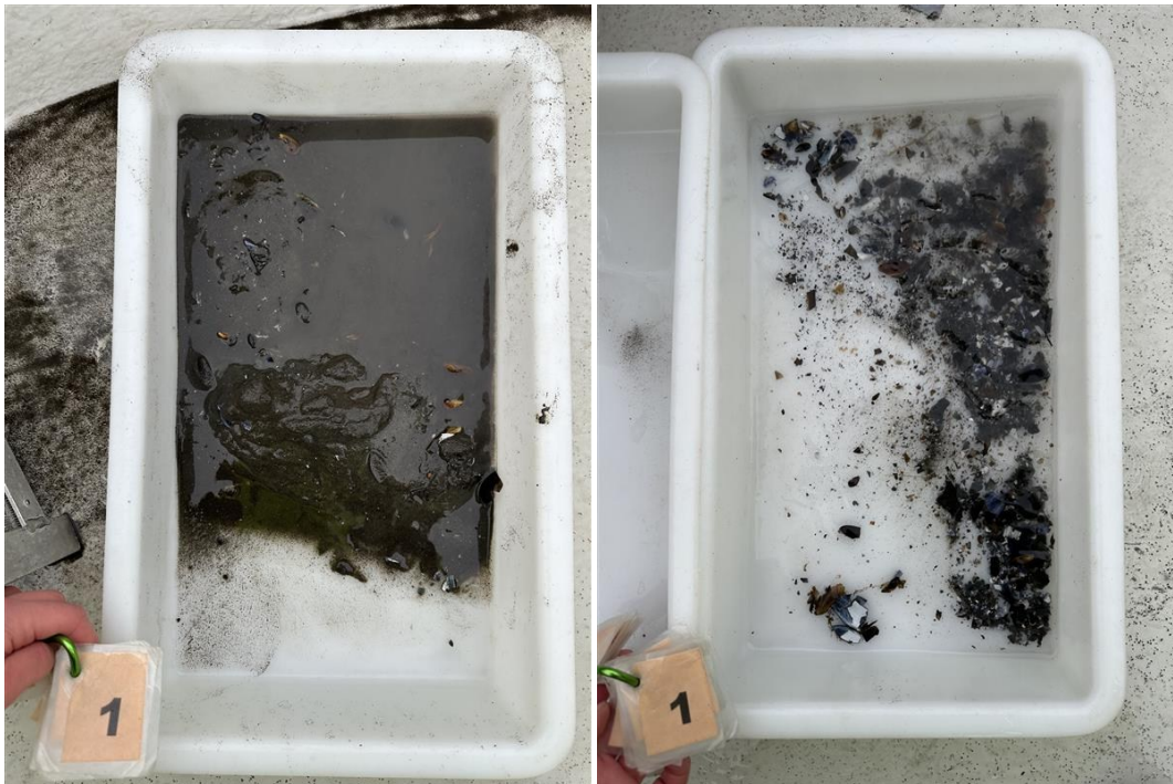
Figur 1: Bilder som viser sedimentet fra stasjon 1 før og etter siling. Sedimentet besto av silt og sand. Foto: Aqua Kompetanse AS.
