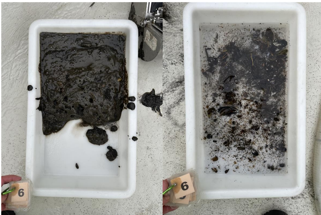
Figur 6: Bilder som viser sedimentet fra stasjon 6 før og etter siling. Sedimentet besto av silt. Det ble registrert rester av fôr og fekalier ved stasjonen. Foto: Aqua Kompetanse AS.
