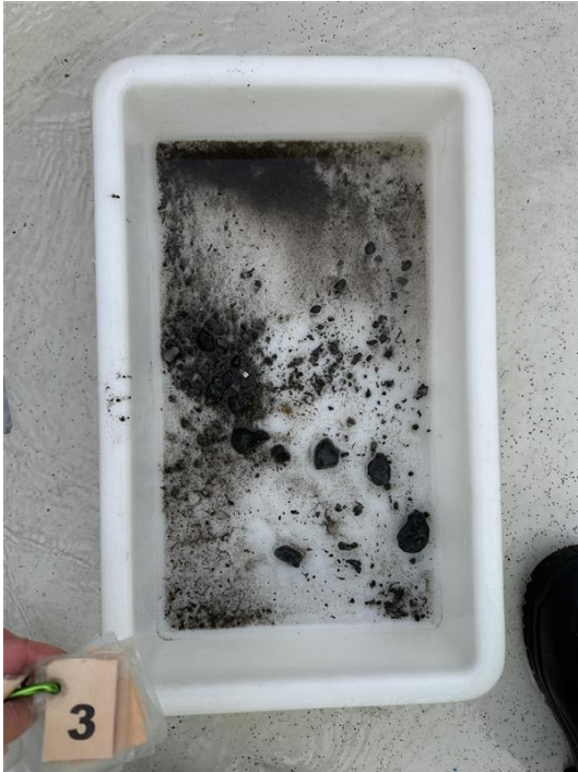
Figur 3: Bilde som viser sedimentet fra stasjon 3. Sedimentet besto av silt og grus. Det ble registrert steinbunn ved stasjonen. Foto: Aqua Kompetanse AS.
