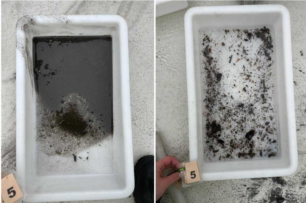
Figur 5: Bilder som viser sedimentet fra stasjon 5 før og etter siling. Sedimentet besto av silt. Foto: Aqua Kompetanse AS.
